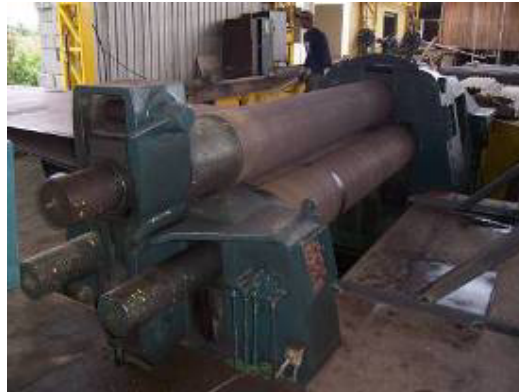
Figura 4.18 Rolado de planchas metálicas
