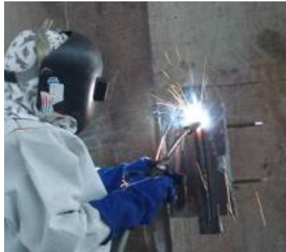
Figura 4.6 Cupón de prueba – FCAW 3G
