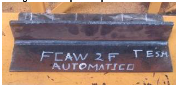
Figura 4.8 Cupón de prueba doble filete – FCAW
