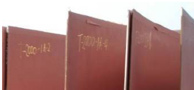
Figura 4.24 Código para la identificación de planchas
