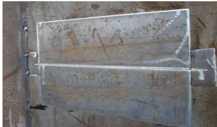
Figura 4.2 Cupón de prueba – SMAW 2G
