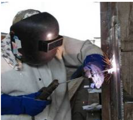
Figura 4.3 Cupón de prueba – SMAW 3G
