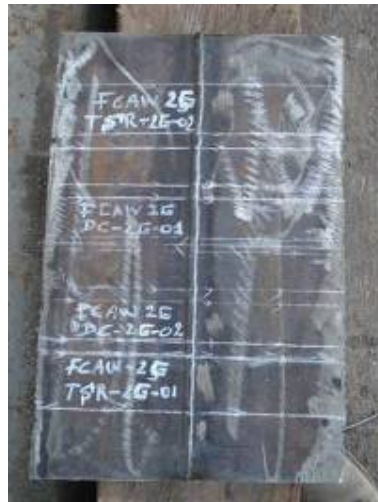
Figura 4.7 Cupón de prueba – FCAW 2G
