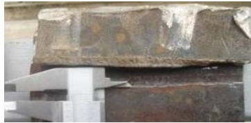
Figura 4.16 Rotura de la junta – penetración del filete
