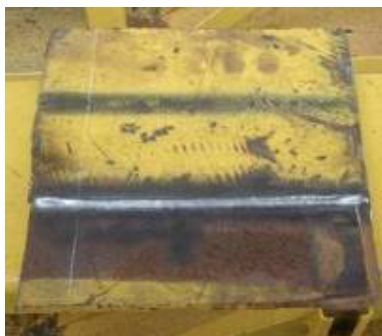
Figura 4.5 Cupón de prueba filete – Traslape SMAW
