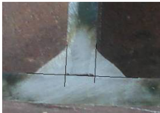
Figura 4.13 (b) Macrografía- Penetración Completa
