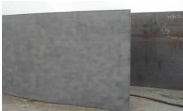
Figura 4.21 Superficies antes y después de sp10 (anillo)
