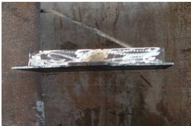
Figura 4.4 Cupón de prueba – SMAW 4G
