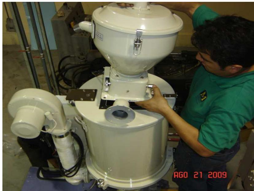
**FIGURA 4.13 MONTAJE DE CARGADOR DE MATERIA PRIMA.**
