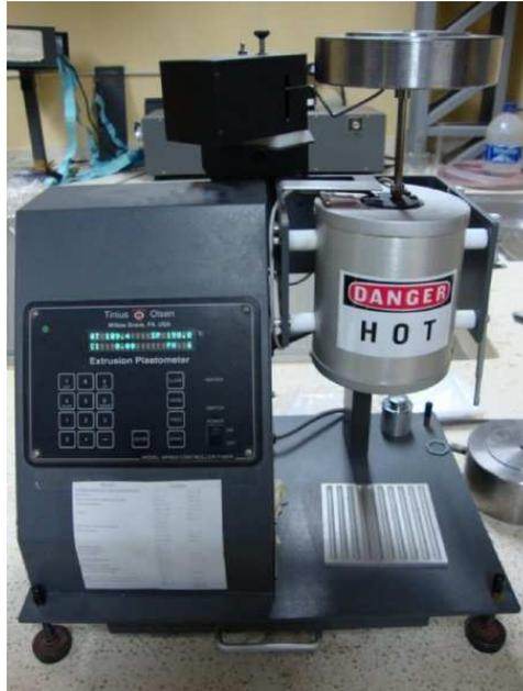
**FIGURA 2.6 EQUIPO DE MEDICIÓN DE ÍNDICE DE FLUIDEZ**
