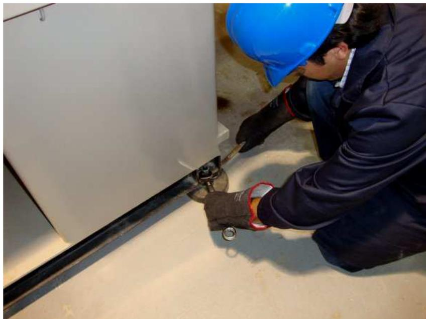
**FIGURA 4.16 ALINEACIÓN Y AJUSTE DE LA INYECTORA**
