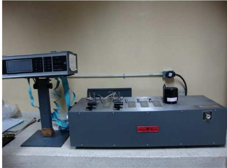
**FIGURA 2.7 MÁQUINA PARA ENSAYO VICAT**
