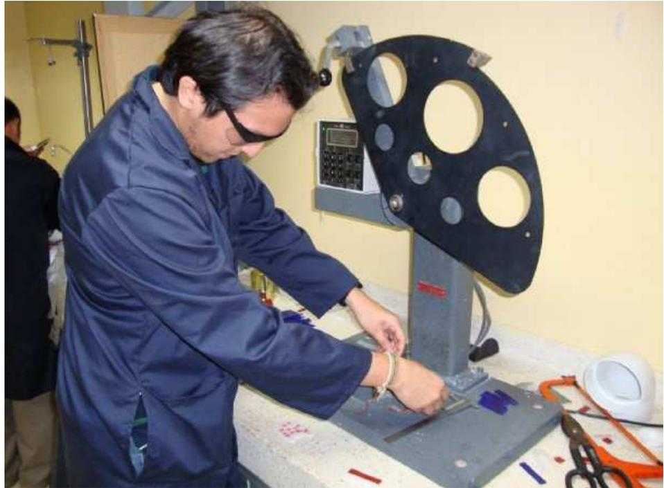
**FIGURA 5.12 ENSAYO DE IMPACTO IZOD**
