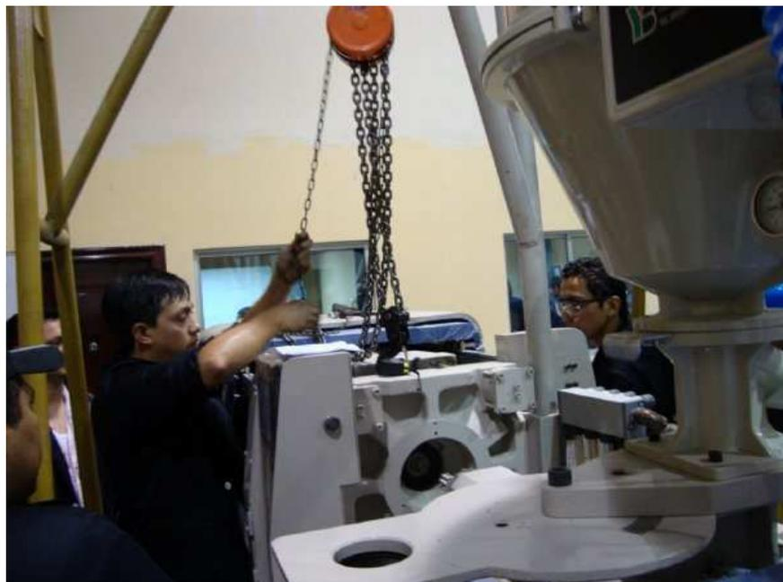
**FIGURA 5.1 MONTAJE DE MOLDE DE LA MÁQUINA INYECTORA.**
