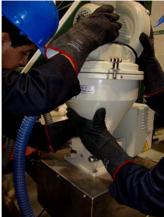
**FIGURA 4.10 MONTAJE DE CARGADOR DE MATERIA PRIMA DE LA MÁQUINA EXTRUSORA.**
