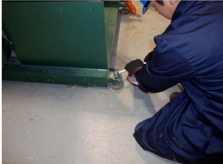
**FIGURA 4.17 ALINEACIÓN Y AJUSTE DE LA EXTRUSORA.**
