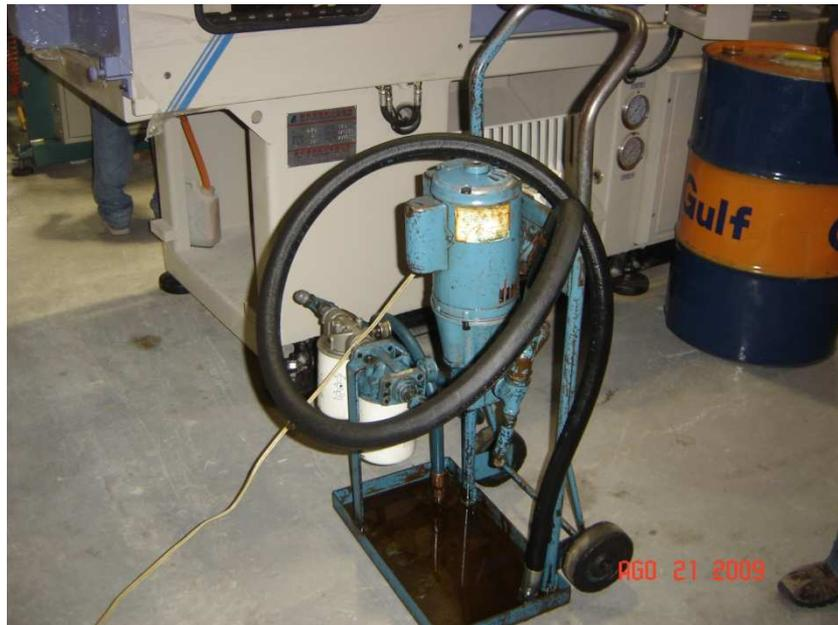
**FIGURA 4.20 BOMBA DE ACEITE Y ACEITE PARA INYECTORA.**
