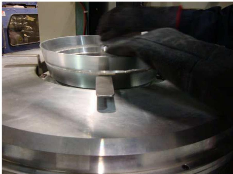
**FIGURA 5.3 MONTAJE MOLDE DE EXTRUSIÓN.**
