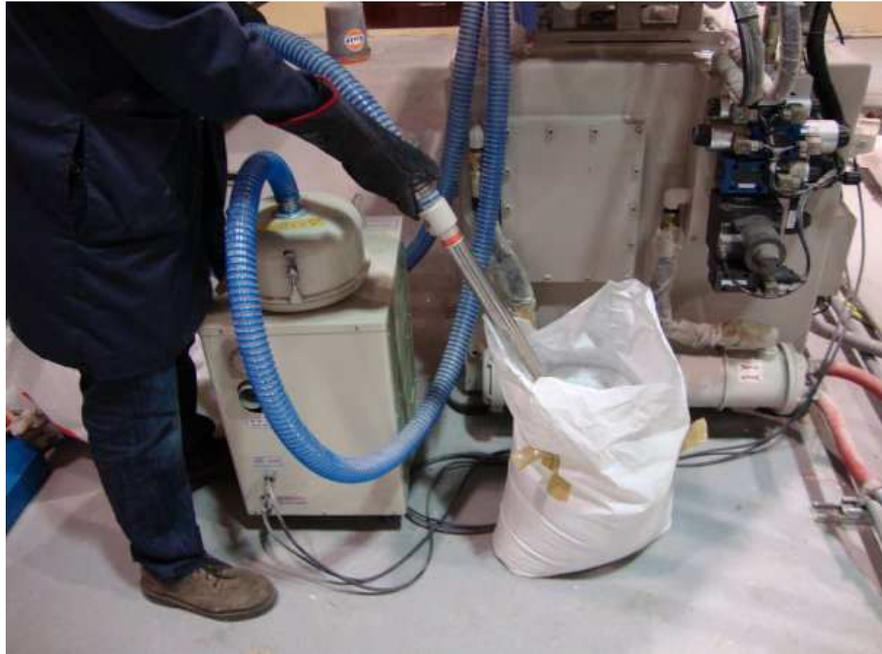
**FIGURA 5.2 SUMINISTRO DE MATERIA PRIMA INYECTORA.**
