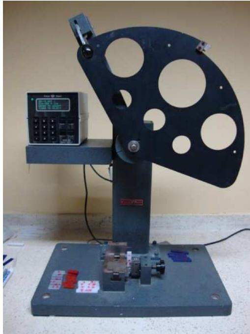
**FIGURA 2.9 MÁQUINA PARA ENSAYO IZOD**
