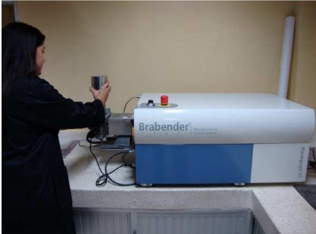
**FIGURA 5.13 ENSAYO REOLÓGICO**
