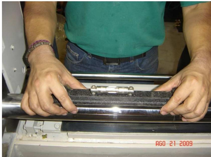
**FIGURA 4.18 NIVELACIÓN DE INYECTORA.**
