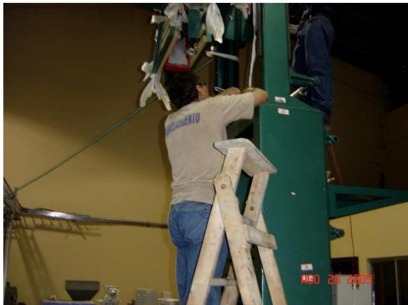
**FIGURA 4.5 MONTAJE DE RODILLOS DE TIRO.**
