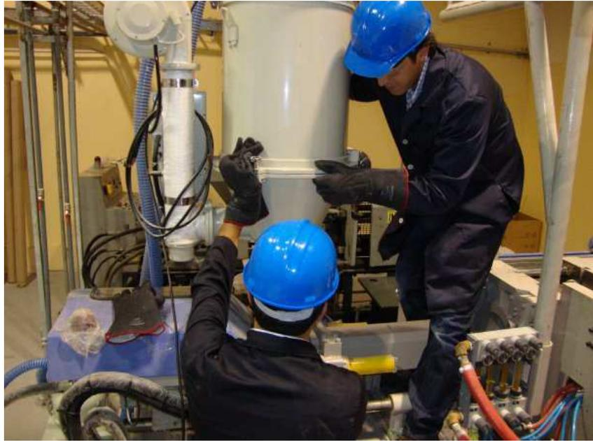
**FIGURA 4.12 MONTAJE DE TOLVA DE SECADO.**
