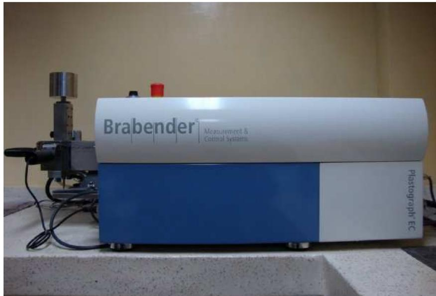
**FIGURA 2.10 EQUIPO BRABENDER PLASTOGRAPH**
