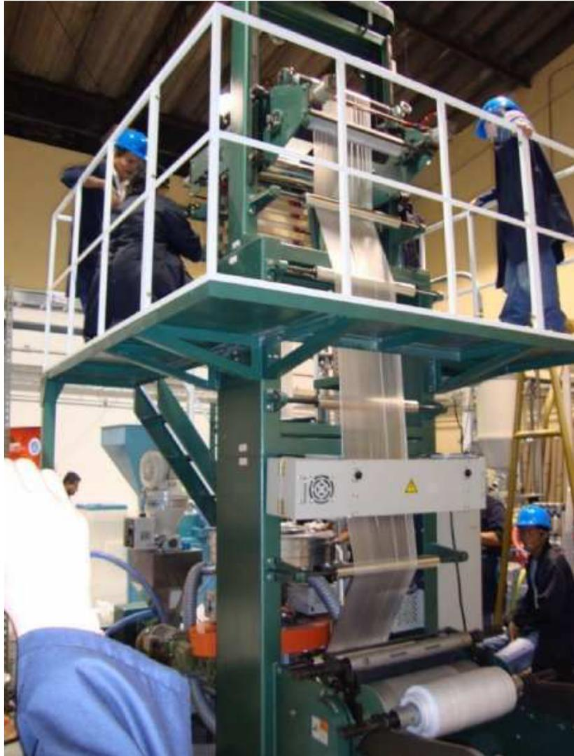
**FIGURA 5.7 MÁQUINA EXTRUSORA EN OPERACIÓN.**
