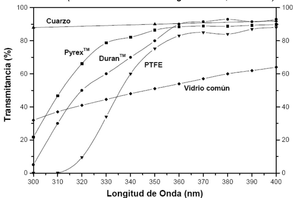
El vidrio es otro material alternativo para fotorreactores. Como puede apreciarse en la figura 12, el vidrio común no es adecuado ya que absorbe parte de la luz UV que llega al fotorreactor, debido al contenido en hierro. Por ello solo resultan adecuados aquellos vidrios que poseen un bajo contenido en hierro, como es el caso del borosilicato (**Figura 19**).
