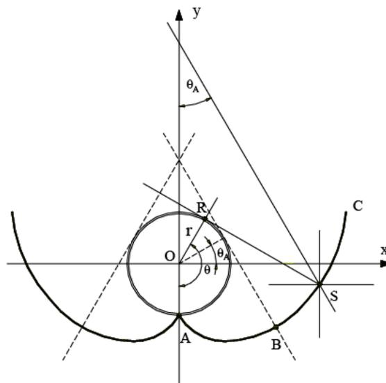
Un parámetro importante para la definición de CPC es el ángulo de aceptación  $2\theta_a$ , que es el rango angular dentro del cual todos los rayos incidentes en el plano de apertura del colector van, bien a incidir directamente sobre el reactor, o bien a ser reflejados sobre el, sin necesidad de mover el conjunto.
