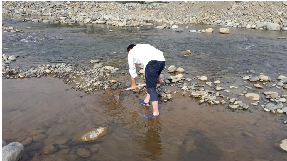
Figura 25. Toma de muestras para realizar ensayos (Lecho de río)
