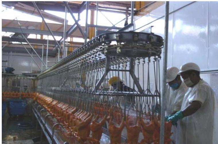
**FIGURA 3.18. Operación de lavado y repaso**
