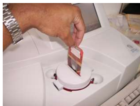
FIGURA 3.26. ESQUEMA DE RADIACIÓN INFRARROJA A TRAVÉS DE UN FILM (19) Y MONTAJE EN EQUIPO.
