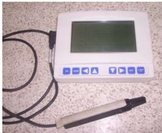
**FIGURA 3.12. HIGRÓMETRO DIGITAL.**
