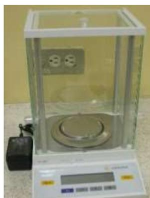
**FIGURA 3.13. BALANZA ANALÍTICA DIGITAL.**
