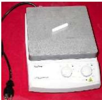
**FIGURA 3.14. AGITADOR MAGNÉTICO.**
