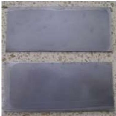
**FIGURA 3.8. PANELES DE ACERO ROLADO EN FRÍO.**
