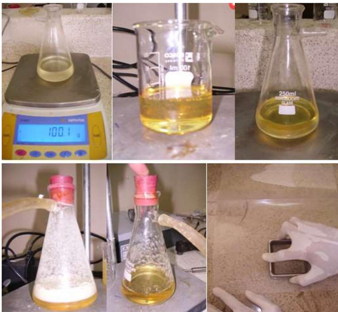
**FIGURA 3.19. SECUENCIA EN EL PROCEDIMIENTO DE FABRICACIÓN Y APLICACIÓN DEL COMPUESTO TRADICIONAL EPÓXICO - POLIAMIDA.**
