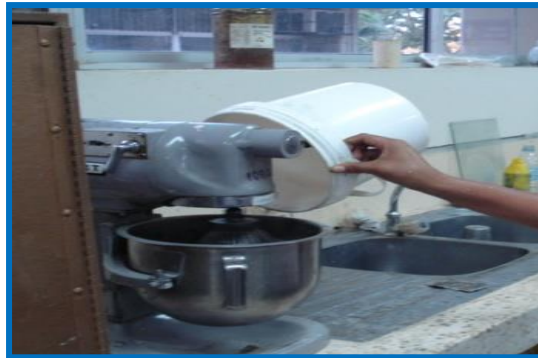
FIGURA. 3.11 PREPARACION DE MEZCLA EN EL MEZCLADOR ELECTRONICO
