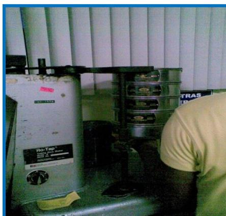
FIGURA 3.7. TAMIZADOR ELECTRICO
