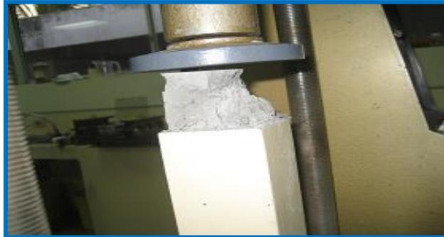
**FIGURA 3.16.** PROBETA DESPUES DE APLICACIÓN DEL ENSAYO DE RUPTURA
