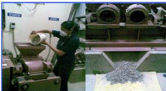
**FIGURA 3.3. TRITURADORA DE RODILLOS
