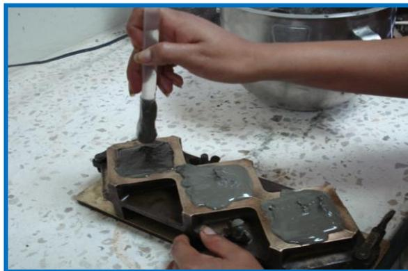
**FIGURA. 3.14.** APLICACION DE LA SEGUNDA CAPA DE MEZCLA
