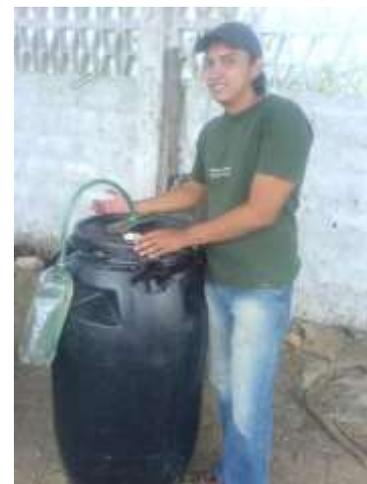
Sellado del tanque y colocación de la botella para facilitar la salida del gas producido por la fermentación
