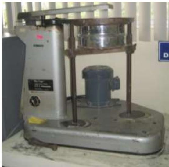
**FIGURA 3.7 TAMIZADOR ELÉCTRICO, CON TAMIZ # 350 Y FONDO**
