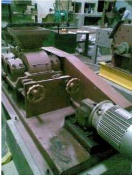
**FIGURA 3.2 TRITURADORA DE RODILLOS**
