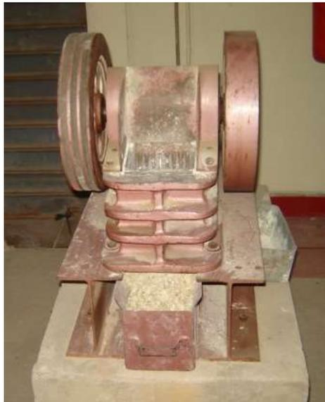
**FIGURA 3.1 TRITURADORA DE MANDÍBULAS**
