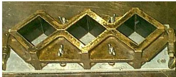
**FIGURA 3.8 MOLDE DE LAS PROBETAS**
