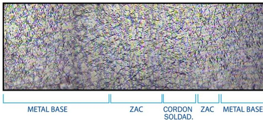
**FIGURA 2.12. MICROESTRUCTURA PROVEEDOR SIDOR 1.1 MM
