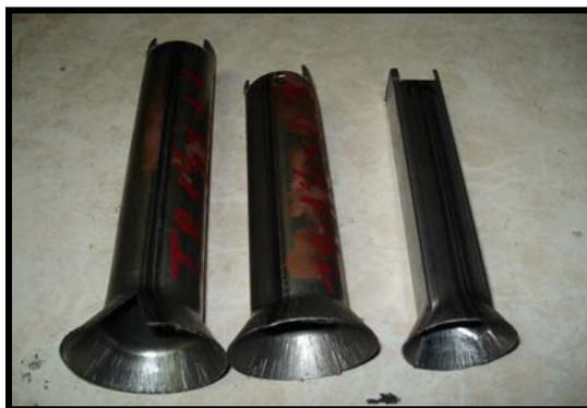
**FIGURA 2.18. PRUEBAS DE ABOCARDADO – PROVEEDOR SIDOR.**
