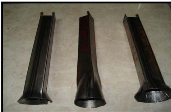
**FIGURA 2.17. PRUEBAS DE ABOCARDADO – PROVEEDOR USIMINAS.**
