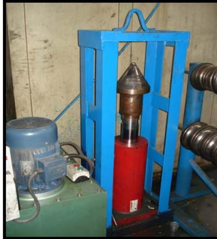
**FIGURA 2.15. EQUIPO PARA PRUEBAS DE ABOCARDADO.**
