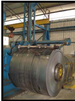
**FIGURA 2.1. CORTADOR DE BOBINAS**
