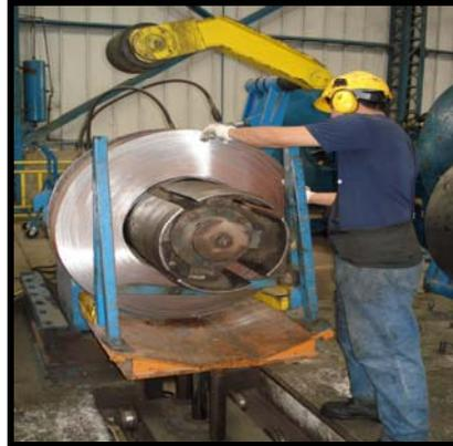
**FIGURA 1.3. COLOCACIÓN DE LAS BOBINAS DE LAMINACIÓN**
