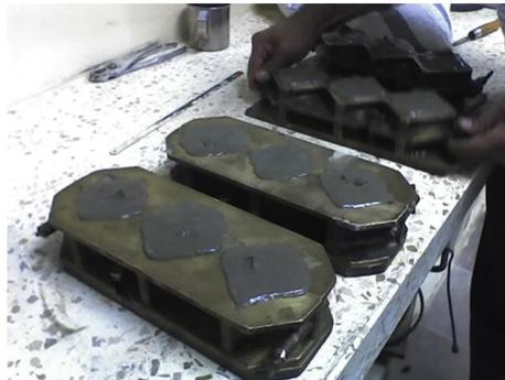
**FIGURA 3.19** COMPACTADO DE PROBETAS
