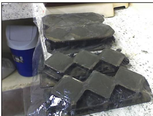
**FIGURA 3.21** PROBETAS CUBIERTAS POR LÁMINAS DE PLÁSTICO
