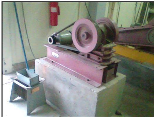
**FIGURA 3.2** MOLINO DE MANDÍBULAS
