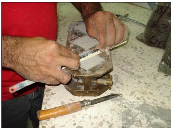
**FIGURA 3.22** RETIRO DE EXCESO DE MEZCLA SECA
