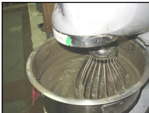
**FIGURA 3.16** CEMENTO-ZEOLITA-AGUA EN LA MEZCLADORA
