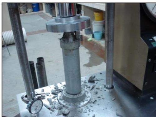
**FIGURA 3.27** RUPTURA DE PROBETAS
