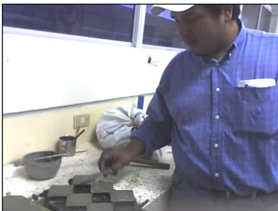
**FIGURA 3.20** RETIRO DE EXCESO DE CEMENTO EN MOLDE.
