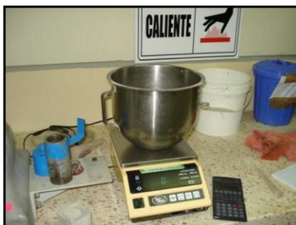
**FIGURA 3.12** BALANZA ELECTRÓNICA ENCERADA
