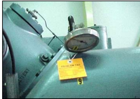
FIGURA 2.5. TARJETAS SEÑALANDO CON CLARIDAD EL PROBLEMA Y LOS REQUERIMIENTOS DE MANTENIMIENTO
