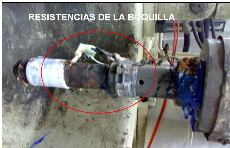
FIGURA 4.8. RESISTENCIAS DE LA BOQUILLA CON MATERIAL
