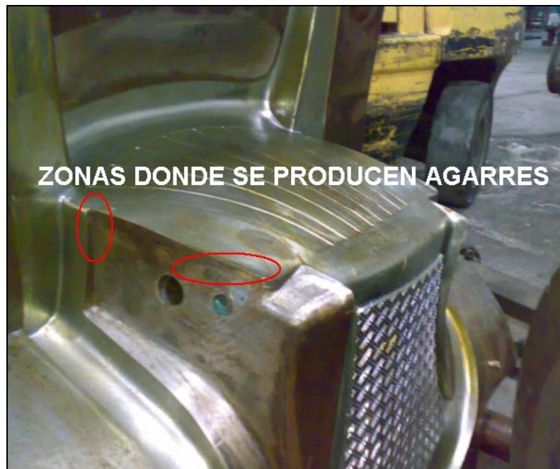
FIGURA 4.3. MOLDE CON DAÑOS POR AGARRE
