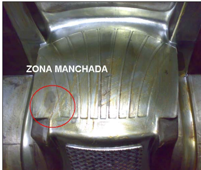
FIGURA 4.5. MANCHA DE MOLDE POR AGUA
