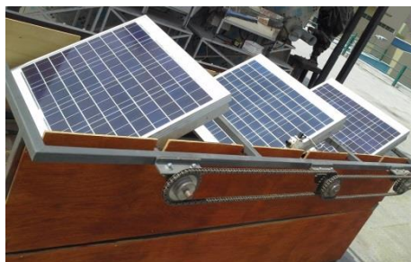
Fig. 3. Ubicación de los paneles solares sobre las claraboyas en el prototipo.
