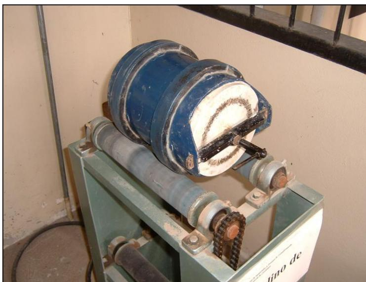
**FIGURA 2.4. MOLINO DE BOLAS DE LA FIMCP EN FUNCIONAMIENTO**
