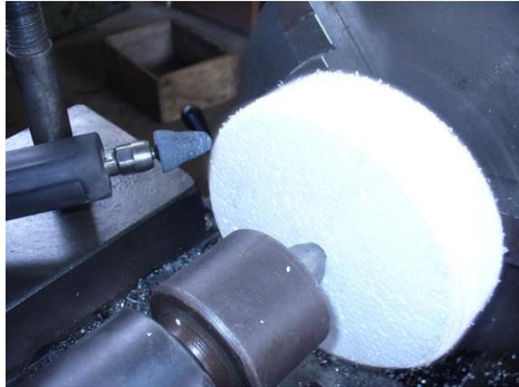
**FIGURA 2.8. PATRÓN DE ESPUMA DE POLIESTIRENO DEL IMPULSOR**
