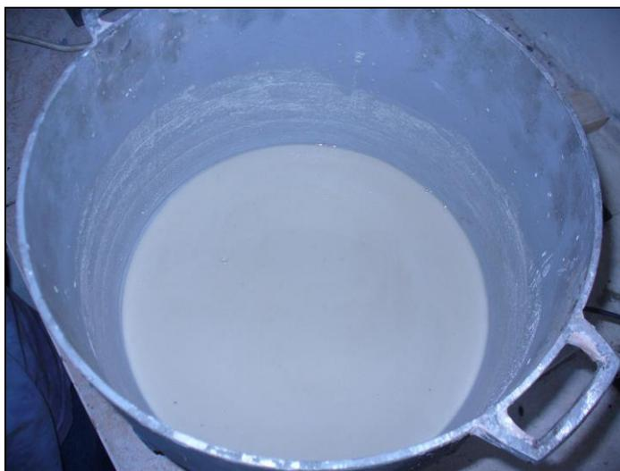
**FIGURA 2.5. PINTURA REFRACTARIA TIPO E A BASE DE AGUA**
