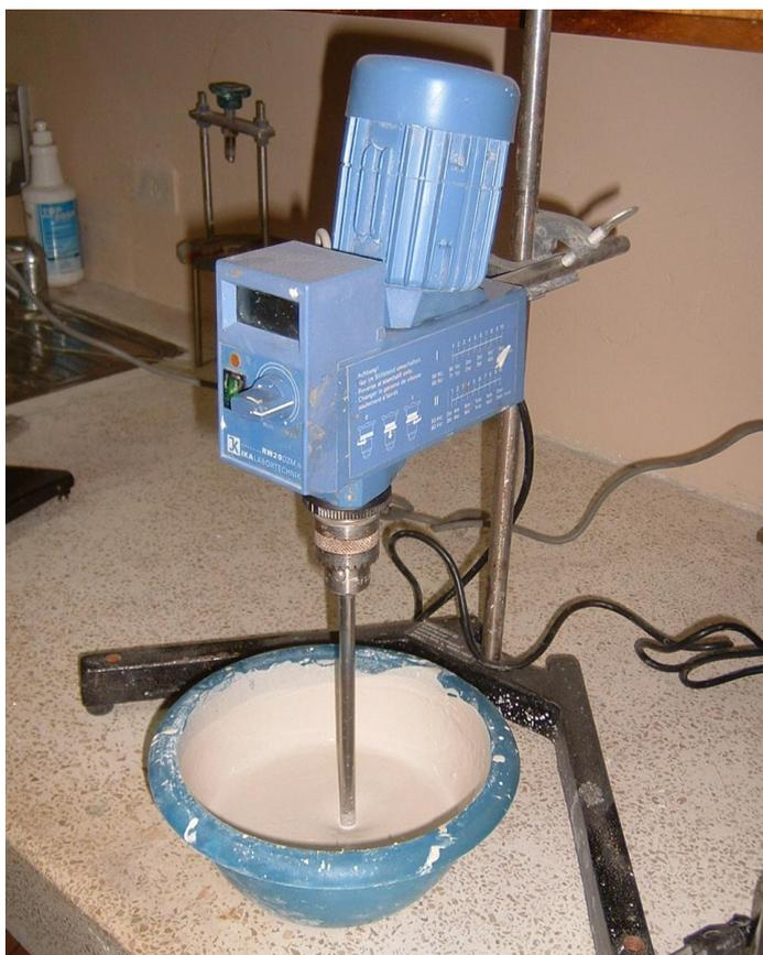
**FIGURA 2.6. AGITADOR MECÁNICO-ELÉCTRICO TRABAJANDO A 200 RPM**
