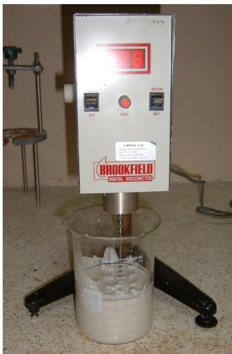
**FIGURA 2.7. VISCOSÍMETRO DE MARCA BROOKFIELD®
