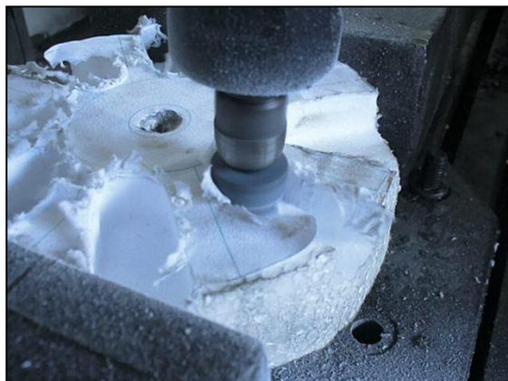
**FIGURA 2.9. MECANIZACIÓN DEL PATRÓN DE ESPUMA DE POLIESTIRENO**
