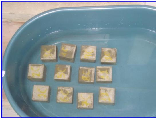
**FIGURA [3.28] PROBETAS SUMERGIDAS EN AGUA**
