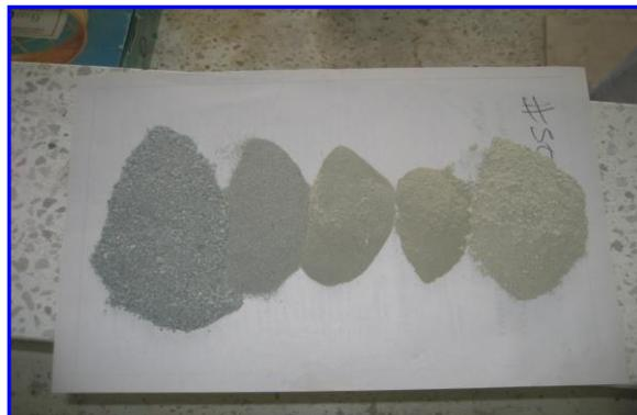
**FIGURA [3.14] GRANULOMETRÍA DEL MATERIAL AL SALIR DEL MOLINO DE DISCOS**
