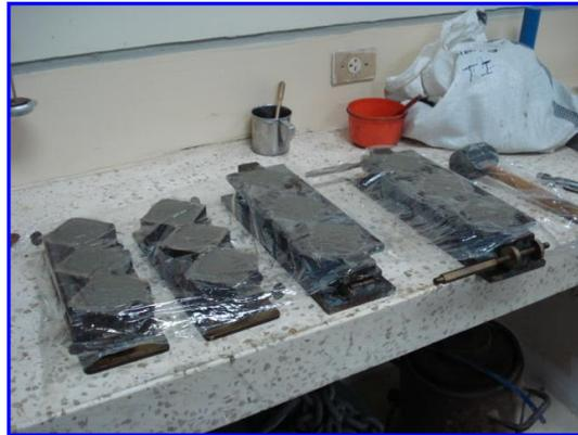
**FIGURA [3.26] PROBETAS CUBIERTAS POR UN PLÁSTICO**
