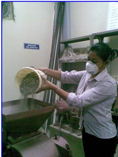
**FIGURA [3.6] ADICIONANDO ZEOLITA EN MOLINO DE RODILLOS**
