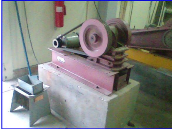
**FIGURA. [3.1] MOLINO DE MANDÍBULAS**
