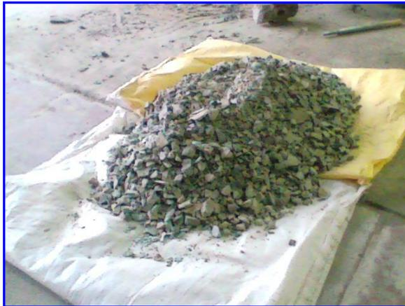
**FIGURA [3.3] GRANULOMETRÍA DE ZEOLITA AL SALIR DE MOLINO DE MANDÍBULAS**
