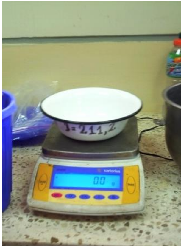
FIGURA 3.2. DISPOSITIVO DE PESAJE Y TAZONES PARA MEDIR LA CANTIDAD DE CEMENTO EN GRAMOS.
