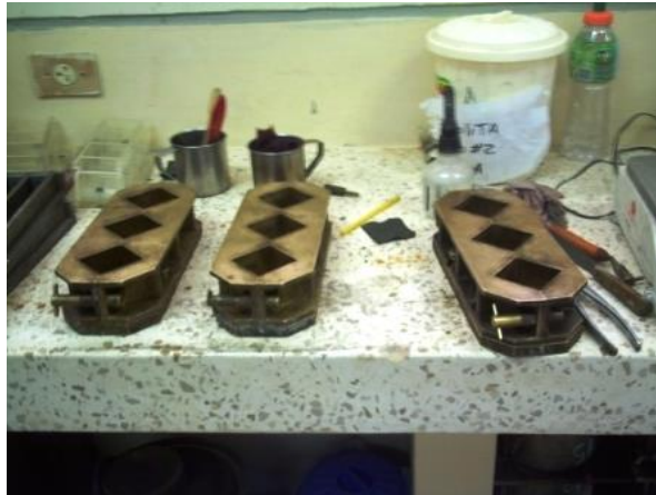
FIGURA 3.3. MOLDES PARA CUBOS DE 50MM MARCA JDBLAB.
