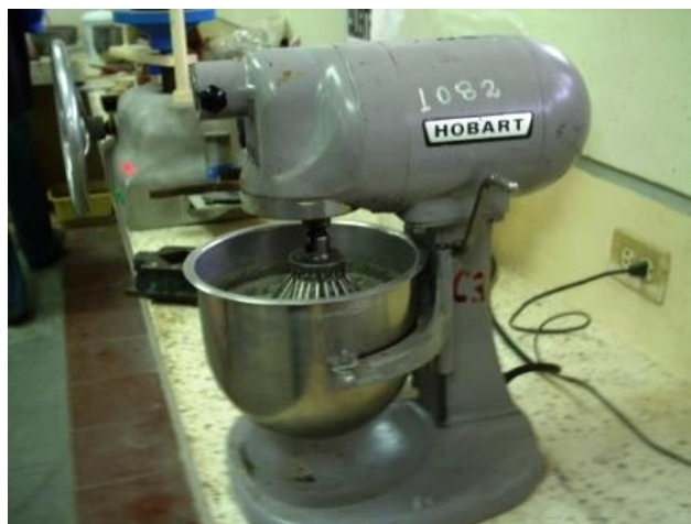
FIGURA 3.4. MEZCLADOR MECANICO CON PALETA Y TAZON.
