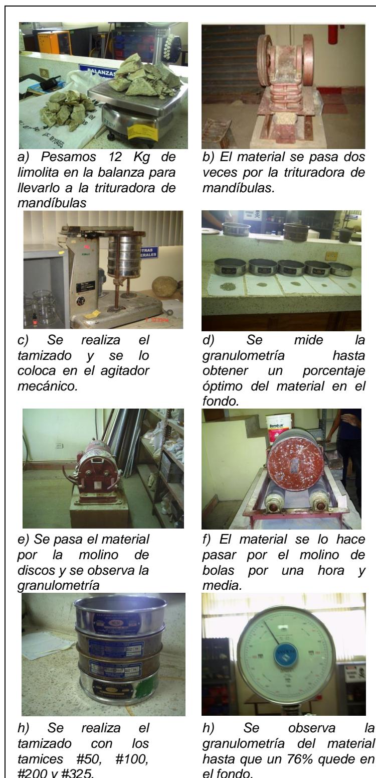
FIGURA 3.1. MOLIENDA DE LA LIMOLITA
