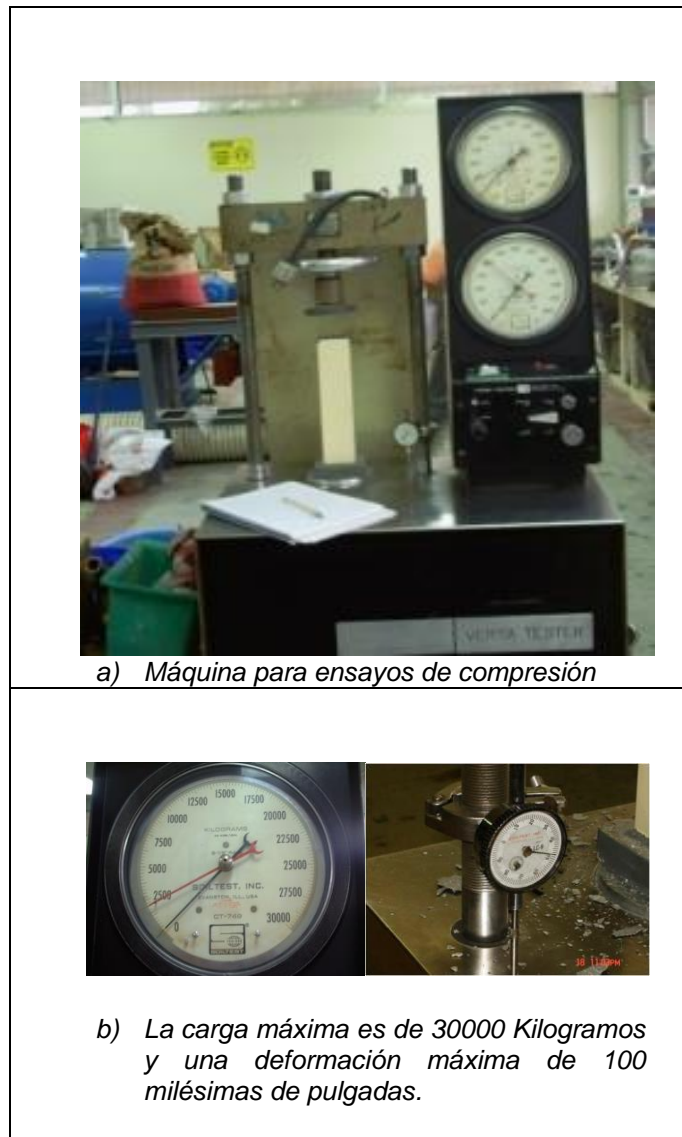
FIGURA 3.5. MAQUINA PARA ENSAYO DE COMPRESION.
