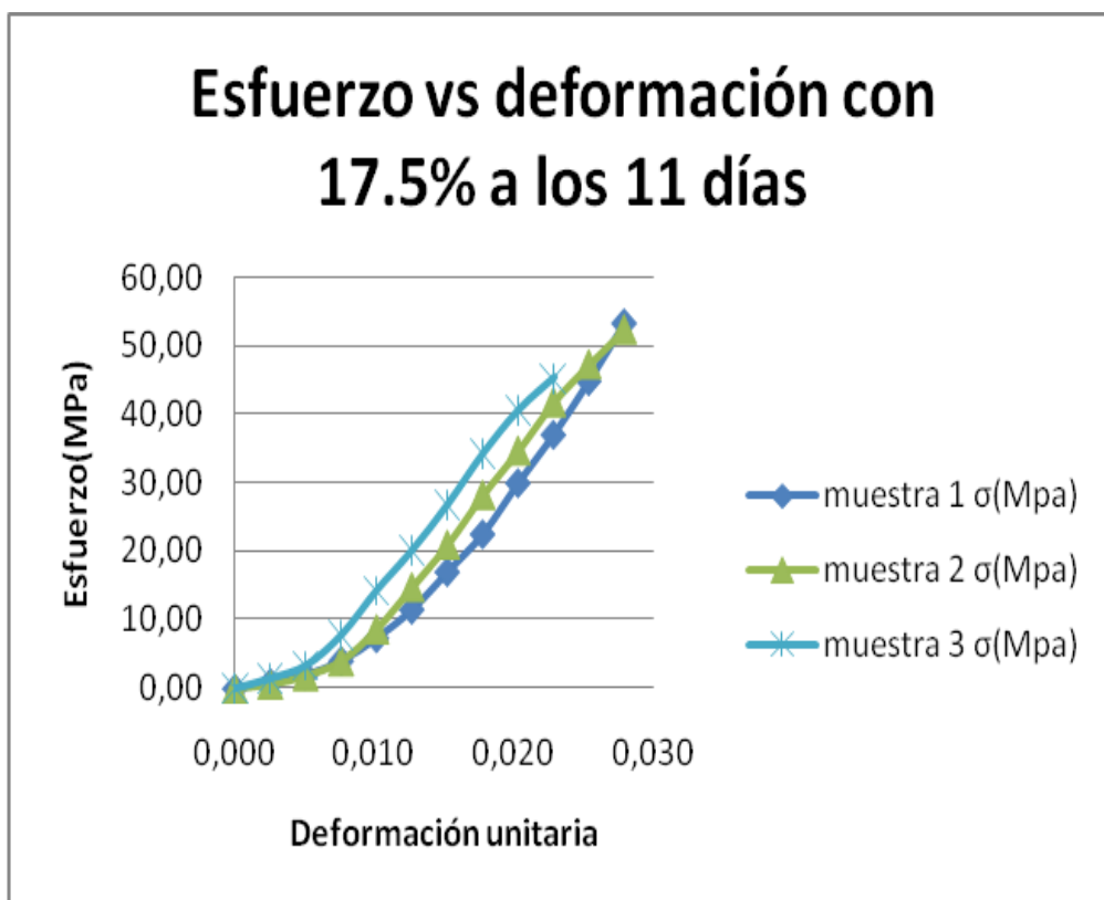
FIGURA 4.6. ESFUERZO DE COMPRESION VS DEFORMACION UNITARIA PARA LAS MUESTRAS A LOS 11 DIAS DE CURADO
