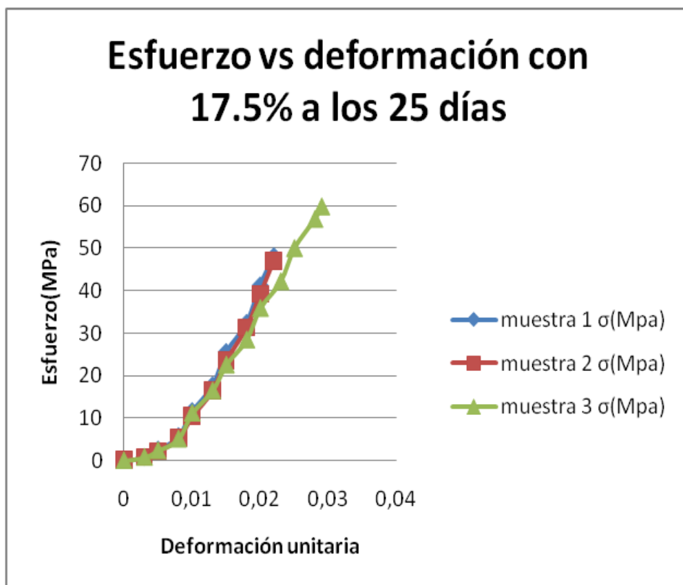
FIGURA 4.8. ESFUERZO DE COMPRESION VS DEFORMACION UNITARIA PARA LAS MUESTRAS A LOS 25 DIAS DE CURADO
