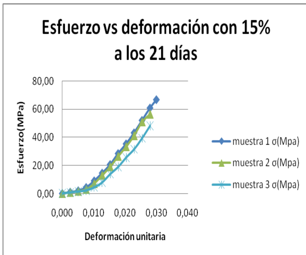
FIGURA 4.3. ESFUERZO DE COMPRESION VS DEFORMACION UNITARIA PARA LAS MUESTRAS A LOS 21 DIAS DE CURADO
