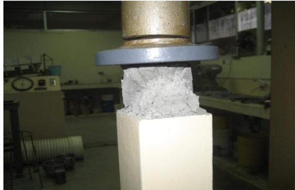
**FIGURA 3.11. PROBETA DEFORMADA EN ENSAYO DE RUPTURA**
