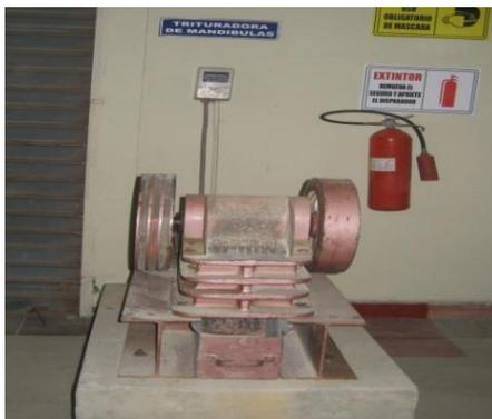
**FIGURA 3.2. TRITURADORA DE MANDÍBULAS**
