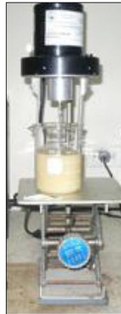
**FIGURA 2.6. SISTEMA PARA LA DETERMINACIÓN DE LA VISCOSIDAD.**
