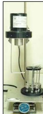
**FIGURA 2.5. VISCOSÍMETRO ROTACIONAL, MARCA BROOKFIELD MODELO RVT**
