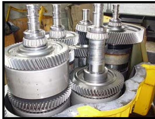
**FIGURA 1.8 TRANSMISIÓN DESMONTADA Y DESCUBIERTA LA CARCASA.**
