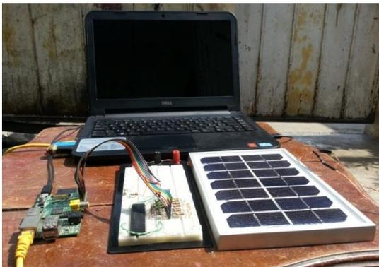
Figura 8. Implementación del Panel Solar con Raspberry PI.
