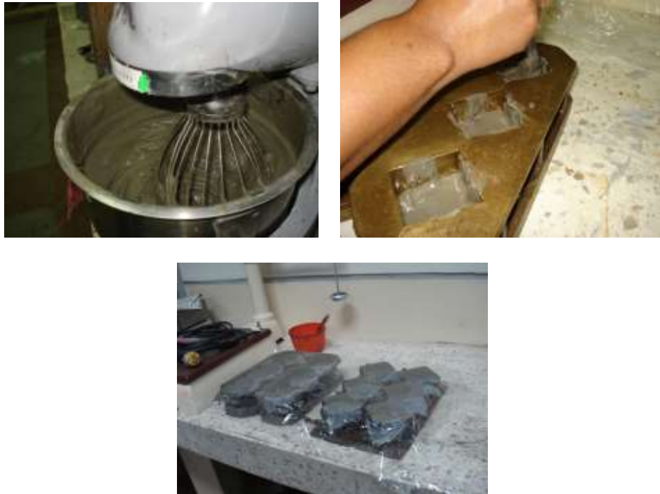
Figura 3.11. Mezclado cemento+zeolita+agua, mezcla vertiéndose en moldes y probetas listas
