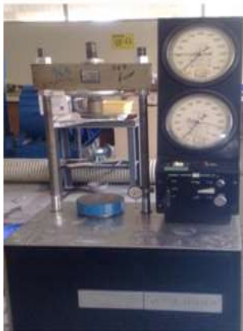
Figura 3.6. Máquinas de ensayos universales Modelos: Versa Tester AP 1020 y CT-900 Norma ASTM C-39
