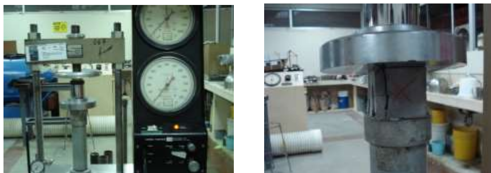
Figura 3.15. Aplicación de fuerza a la muestra y después de aplicada
