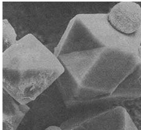
Figura 2.3. Zeolita faujasita. Observada en el microscopio electrónico de barrido. Los cristales son de 50 Å aproximadamente.
