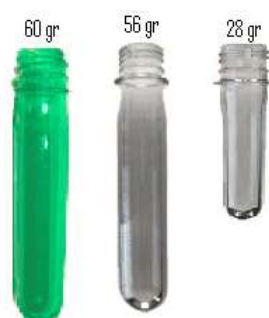
FIGURA 1.4 PREFORMAS PRODUCTO TERMINADO DEL ÁREA DE INYECCIÓN
