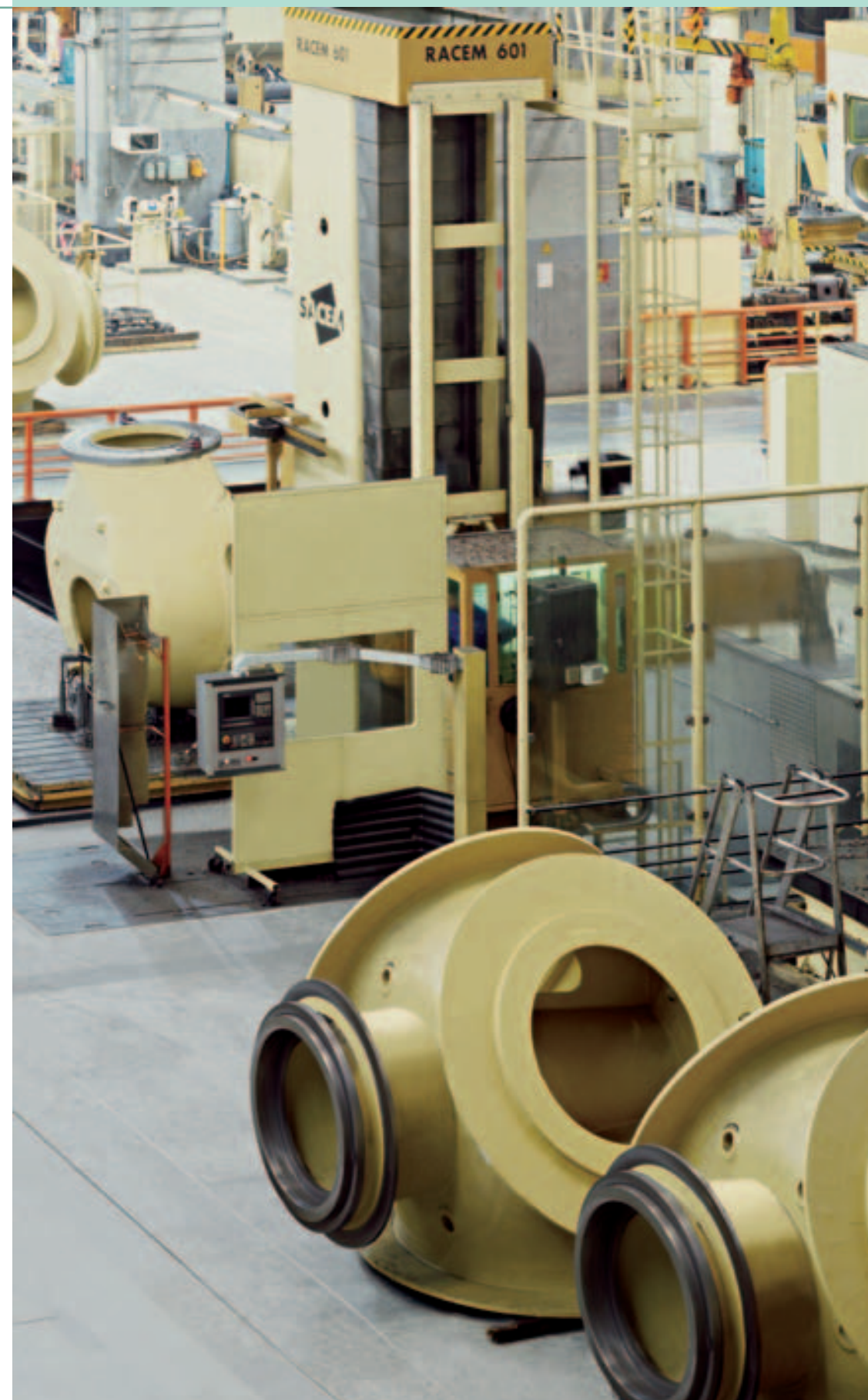
Todos los componentes principales como el buje, el adaptador de las palas, eje y soporte principales se fabrican en fundición de grafito esferolítico y, a continuación, se moldean
