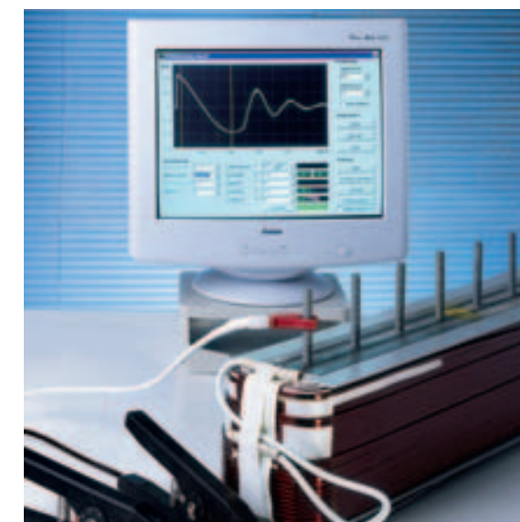
Sistema de calidad ENERCON – Test de impulsos de tensión en polos y bobinas
