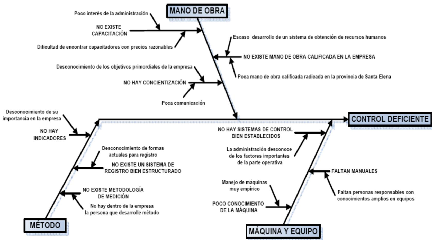
FIGURA 3.23 DIAGRAMA DE CAUSALIDAD PARA EL CONTROL DEFICIENTE
