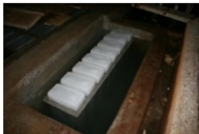
**FIGURA 3.8 OPERACIÓN DE DESMOLDEO**
