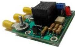
**Figura 7.** Módulo Idetec sensor de temperatura
