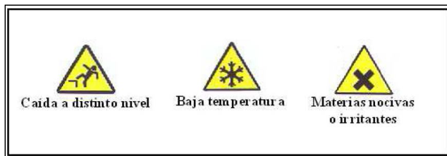
Figura 2.9.2 Señales de Advertencia.
