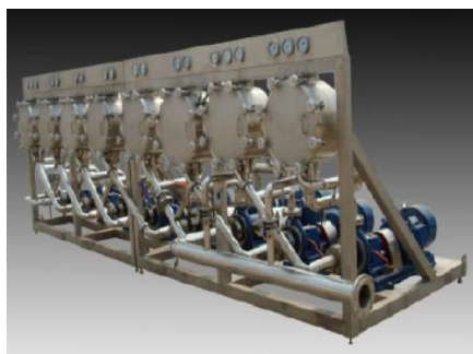
Figura 2.5.4 Imagen del equipo Hidrociclón, Separación del almidón y la proteína.
