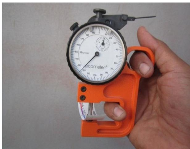
*Foto 8 Medición del Perfil de Anclaje<sup>36</sup>*
