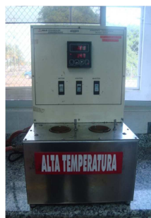
Figura 1.26 - Consistómetro de presión atmosférica. Fuente: BJ-Services.
