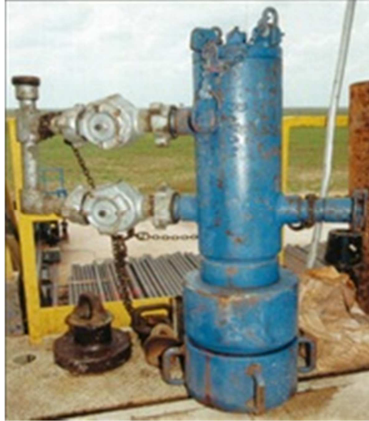
Figura 1.8 - Cabezal de cementación. Fuente: BJ-Services.
