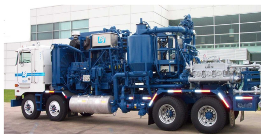
Figura 1.9 - Unidad de cementación on-shore. Fuente: BJ-Services.
