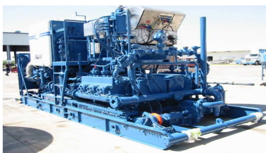
Figura 1.10 - Unidad de cementación off-shore. Fuente: BJ-Services.
