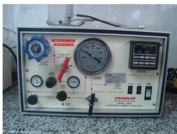
Figura 1.25 - Analizador ultrasónico de cemento. Fuente: BJ-Services.
