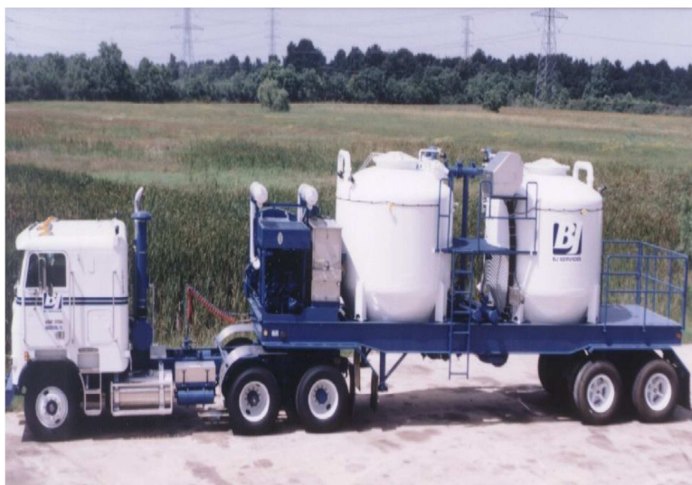
Figura 1.11 - Unidad de mezcla o batch mixer.
