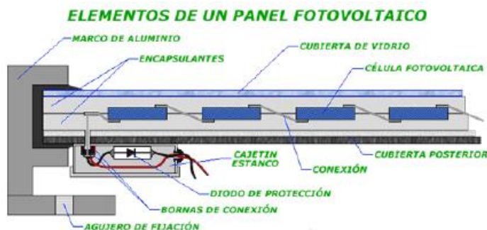
Figura 2.9: Sección del módulo fotovoltaico
