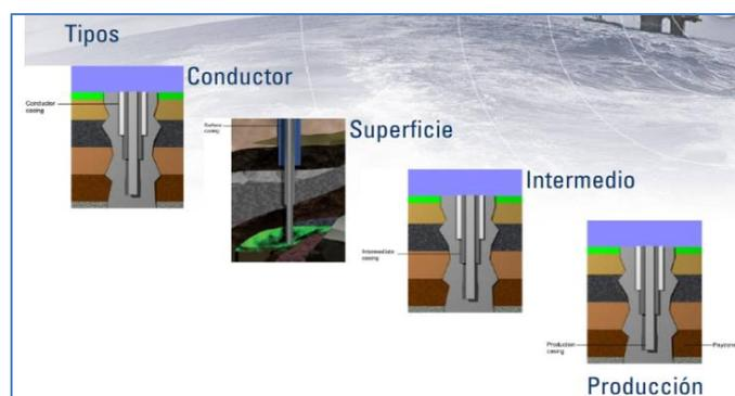
Figura 1: Revestidor. Fuente: "Internet"
