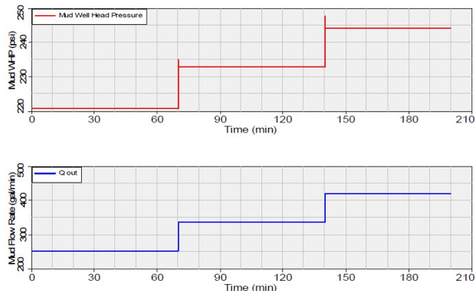
Figura 10: Presión de circulación. Fuente: “Schlumberger”
