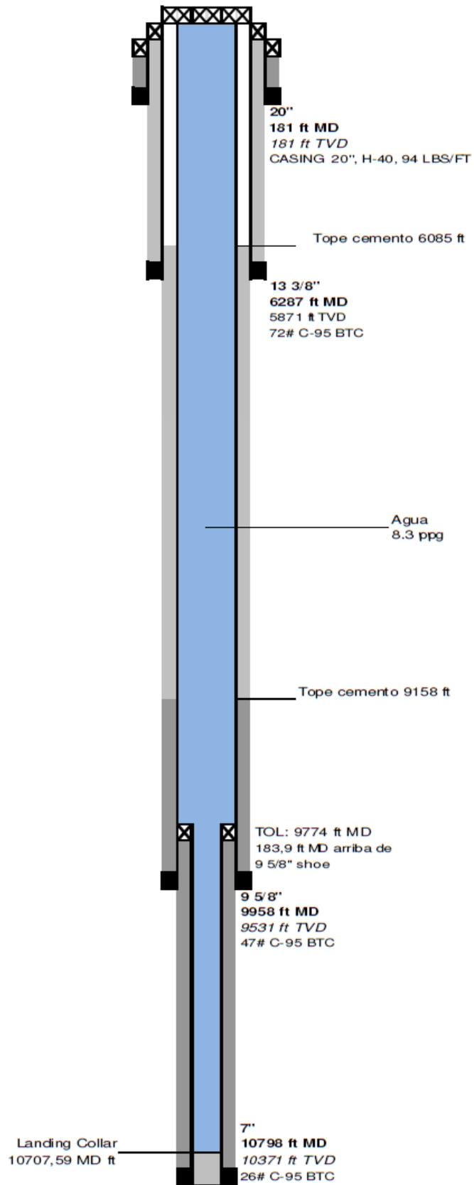
Figura 11: Diagrama Mecánico Final con Liner Setting Tool en Superficie. Fuente: "Schlumberger"
