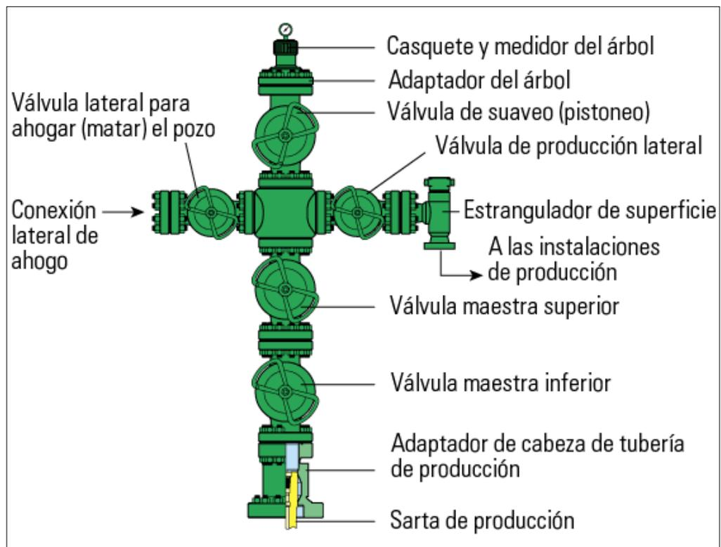
Fig. 3.14 Partes de un Árbol de Navidad. Fuente: "Outfield Glossary" de Schlumberger.
