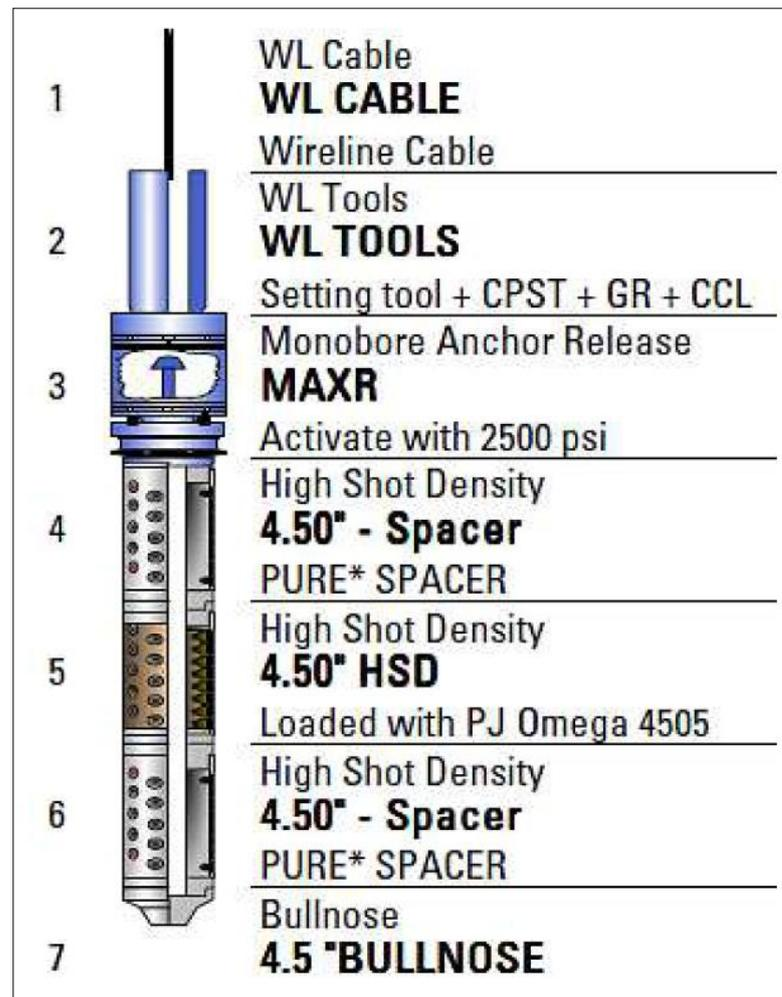
Fig. 2.6 Componentes del sistema "Max - R". Fuente: Schlumberger.
