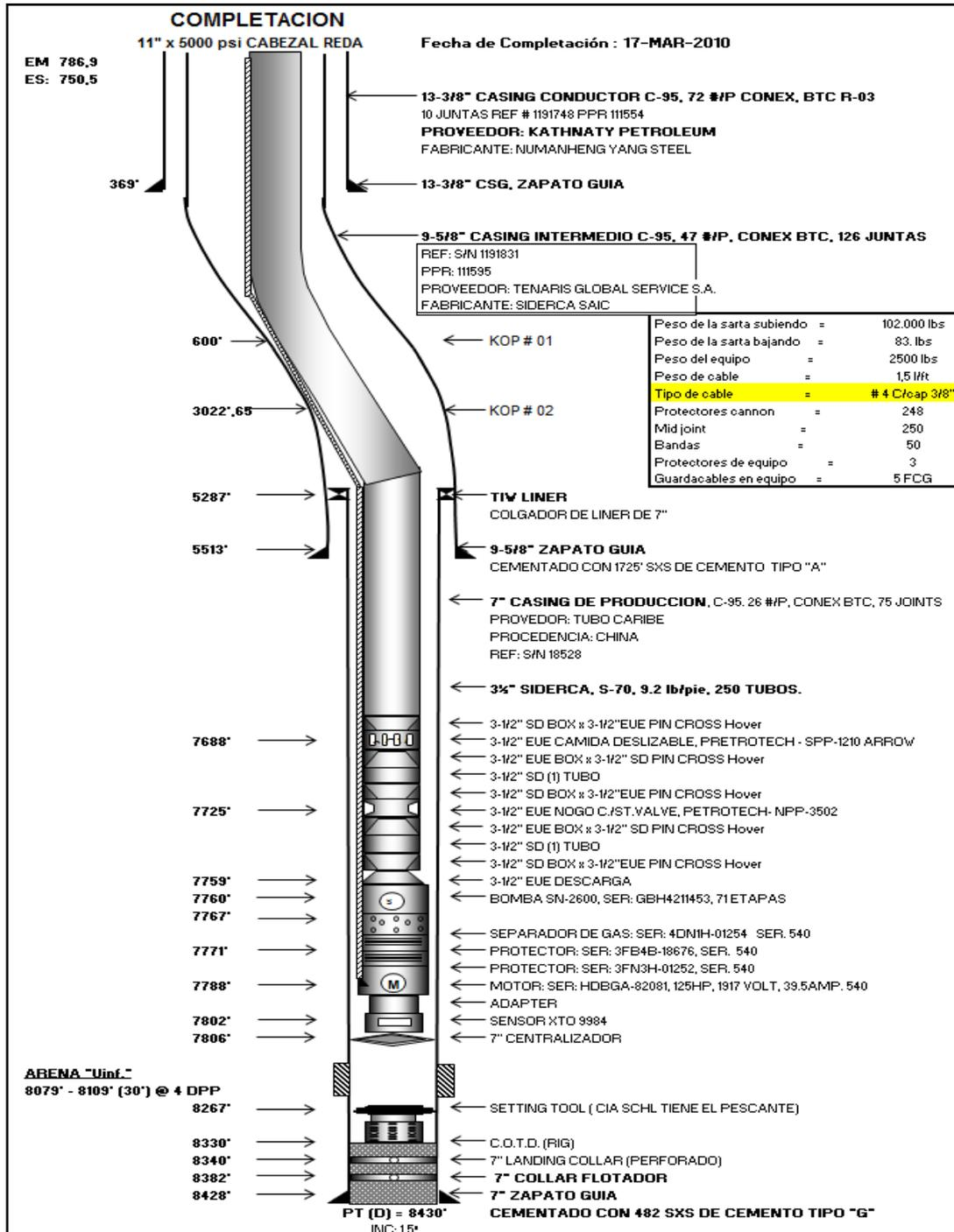
Fig. 5.18 Diagrama de Completación Pozo ESPOL 03-D.
