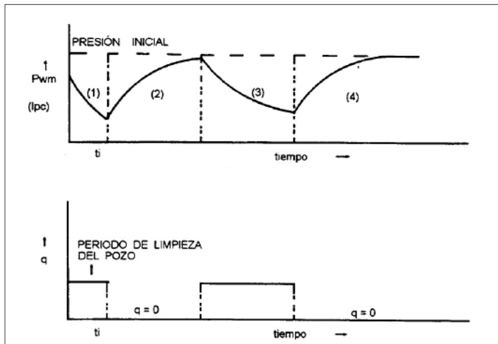
Fig. 2.9 Procesos de la Prueba DST. Fuente: *Análisis de Pruebas de Presión de CIED PDVSA*.
