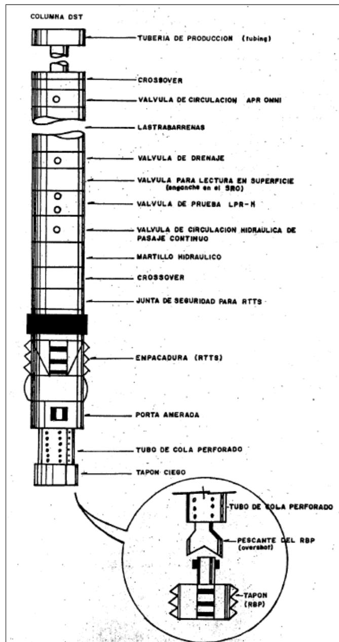
Fig. 2.10 Componentes del equipo DST. Fuente: Manual de Completación del Ing. Kleber Quiroga.
