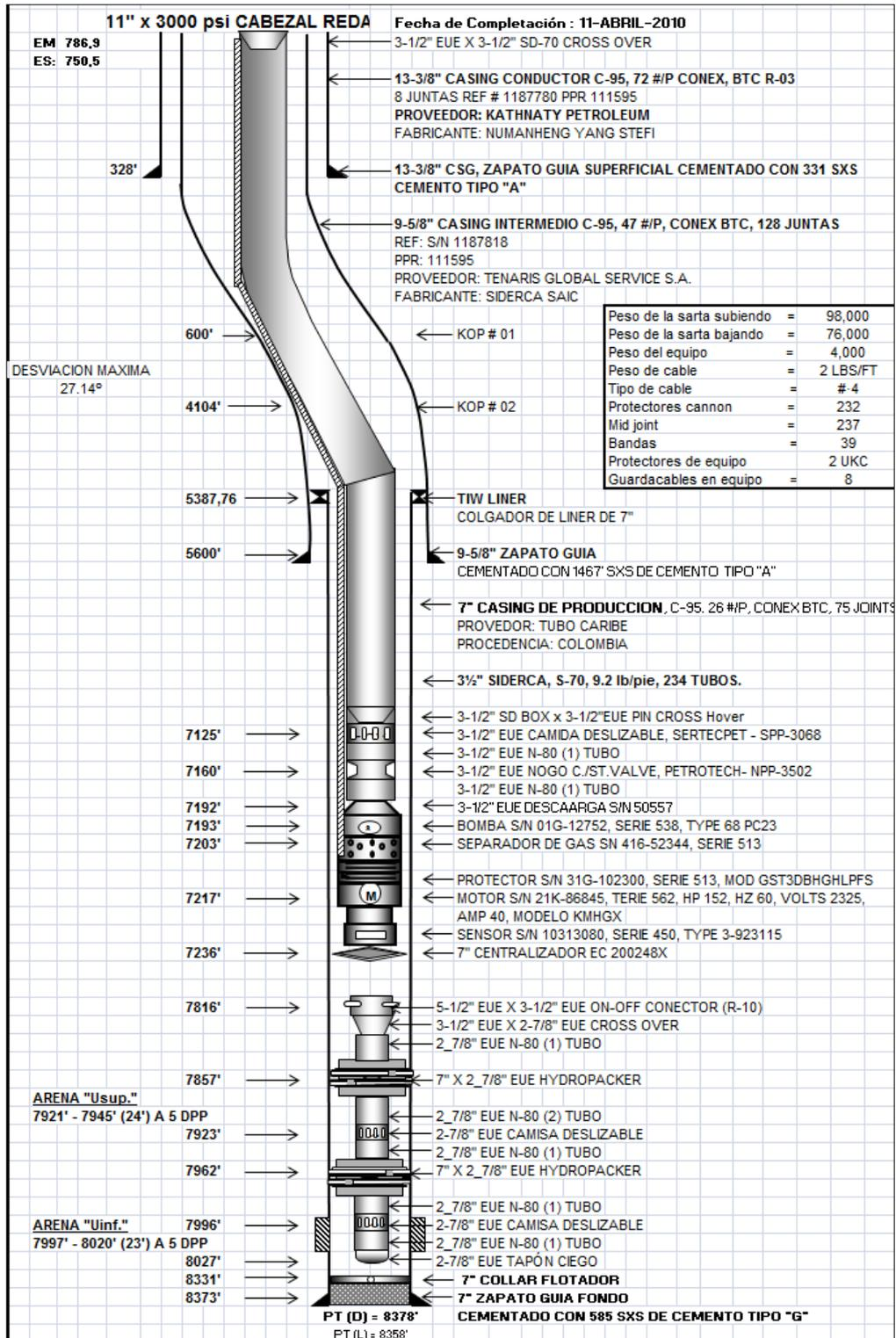
Fig. 3.15 Componentes de una sarta de completación para producir con Sistema BES.
