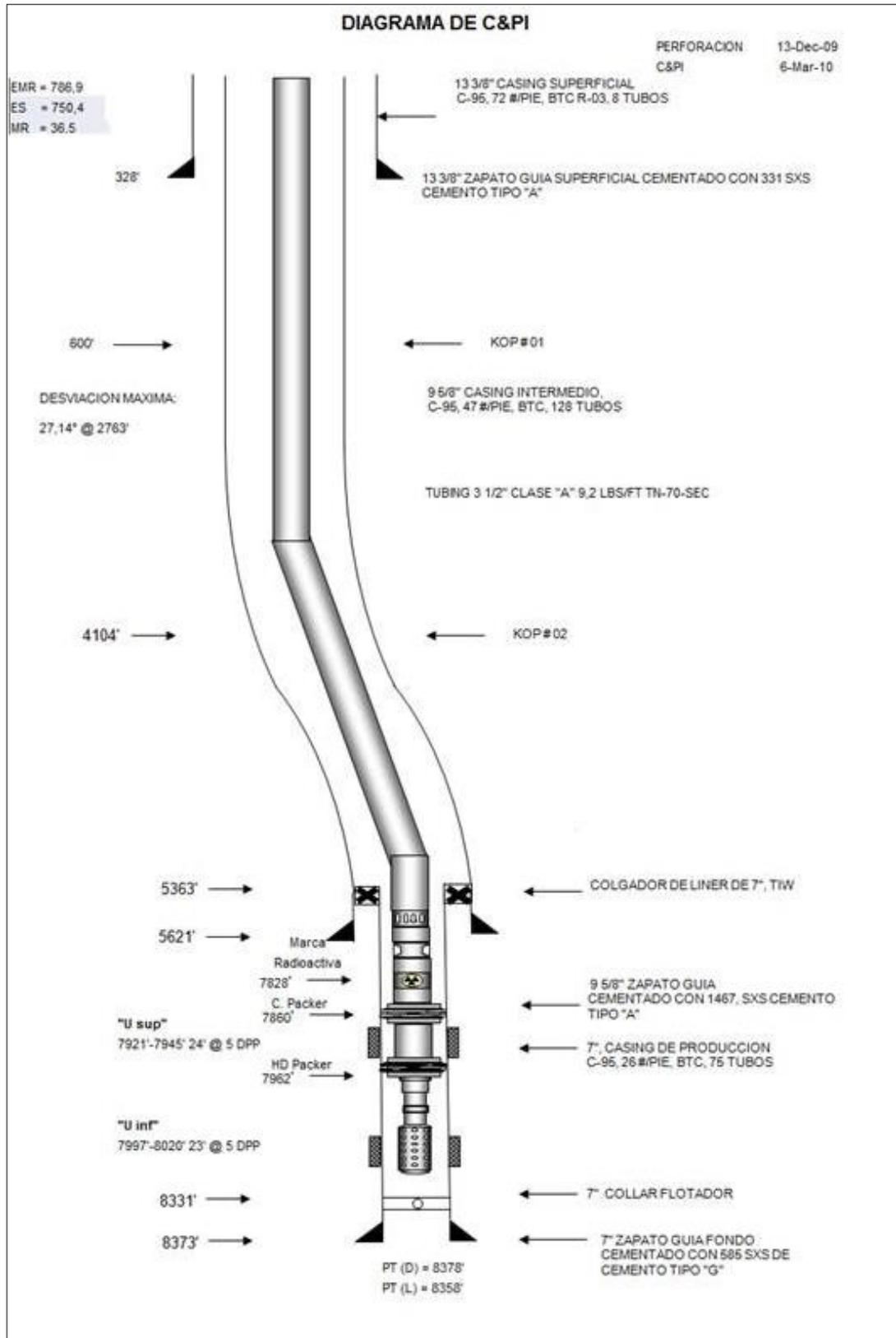
Fig. 1.2 Diagrama de Completación a Hueco Revestido.
