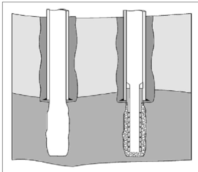
Fig. 1.1 Completaciones a Hueco Abierto. Fuente: *Manual de Completación Schlumberger*.
