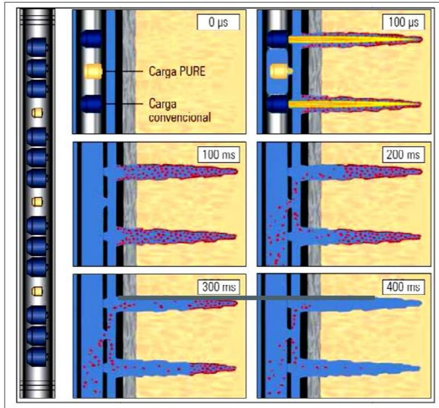
Fig. 2.8 Proceso de disparo del Sistema de cañoneo "PURE". Fuente: "Oilfield Review" de Schlumberger.
