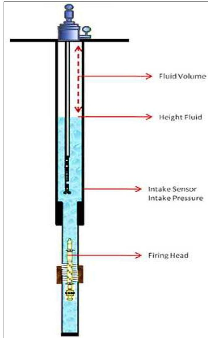
Fig. 2.7 Configuración del sistema "One-Trip". Fuente: Schlumberger.
