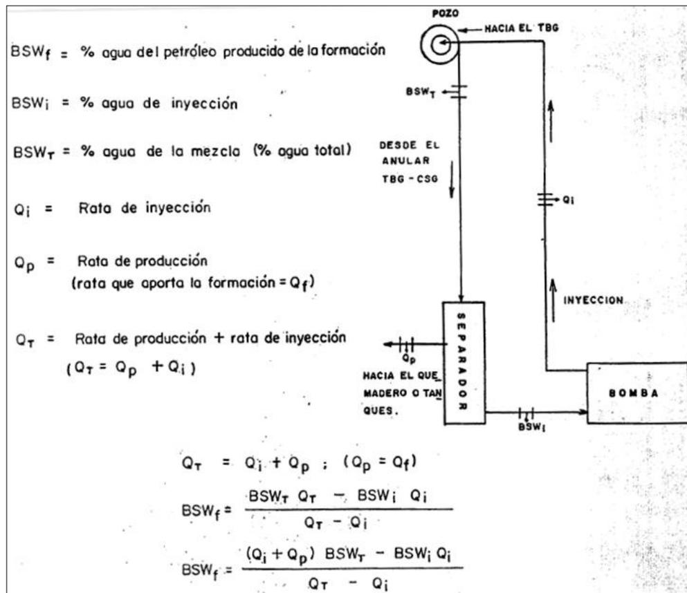
Fig. 2.11 Ecuaciones y esquema de distribución para evaluación con bomba Jet. Fuente: *Manual de Completación del Ing. Kleber Quiroga.*
