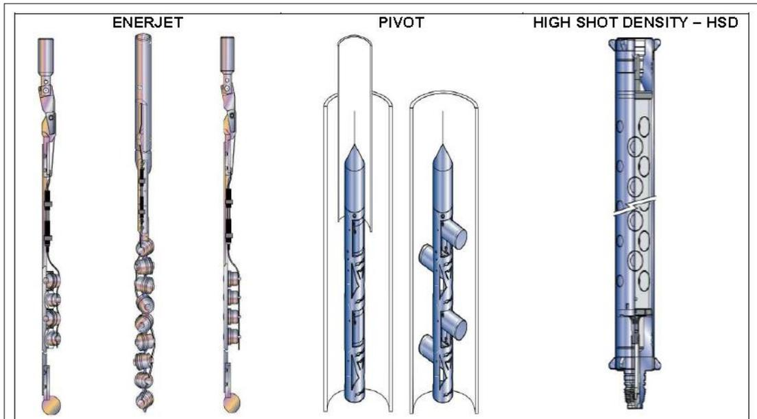
Fig. 2.3 Tipos de Cañón de "Tubing". Fuente: Schlumberger.
