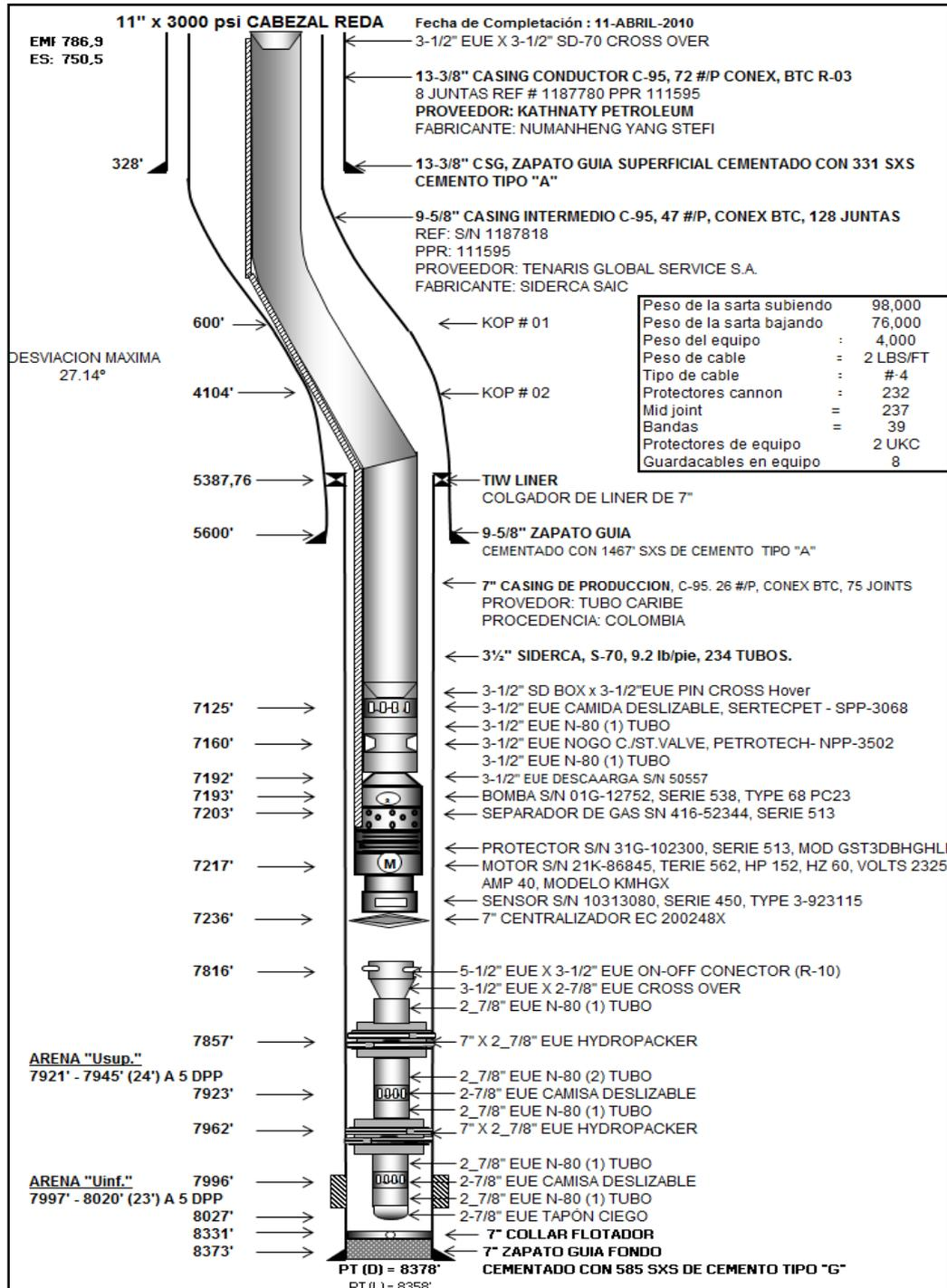
Fig. 5.17 Diagrama de Completación Pozo ESPOL 02-D.
