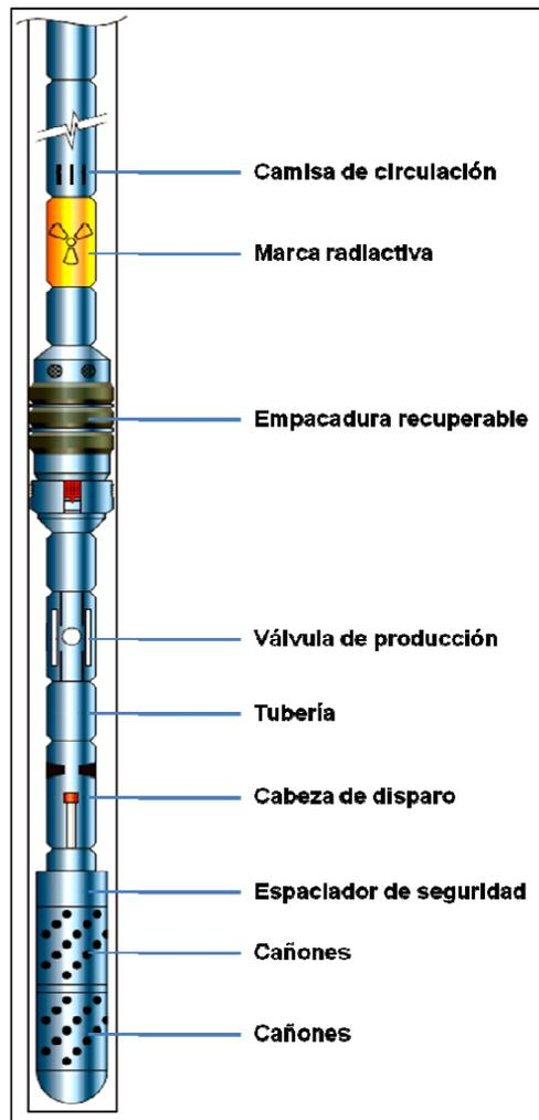
Fig. 2.5 Configuración de una sarta con Cañón TCP. Schlumberger.
