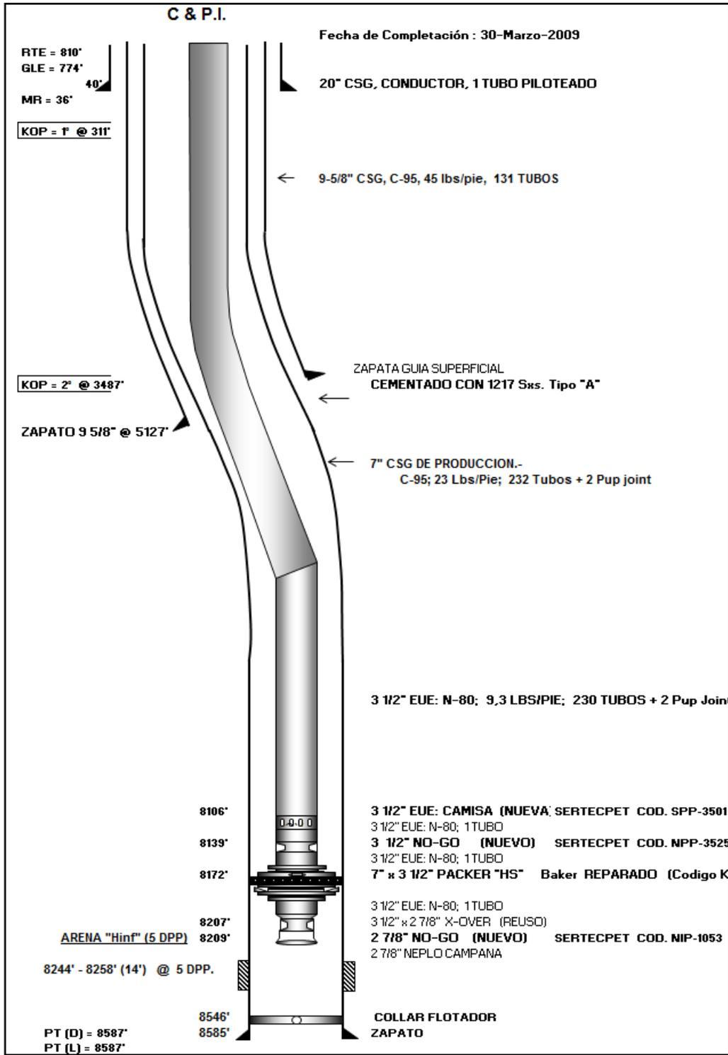
Fig. 5.16 Diagrama de Completación Pozo ESPOL 01-D.
