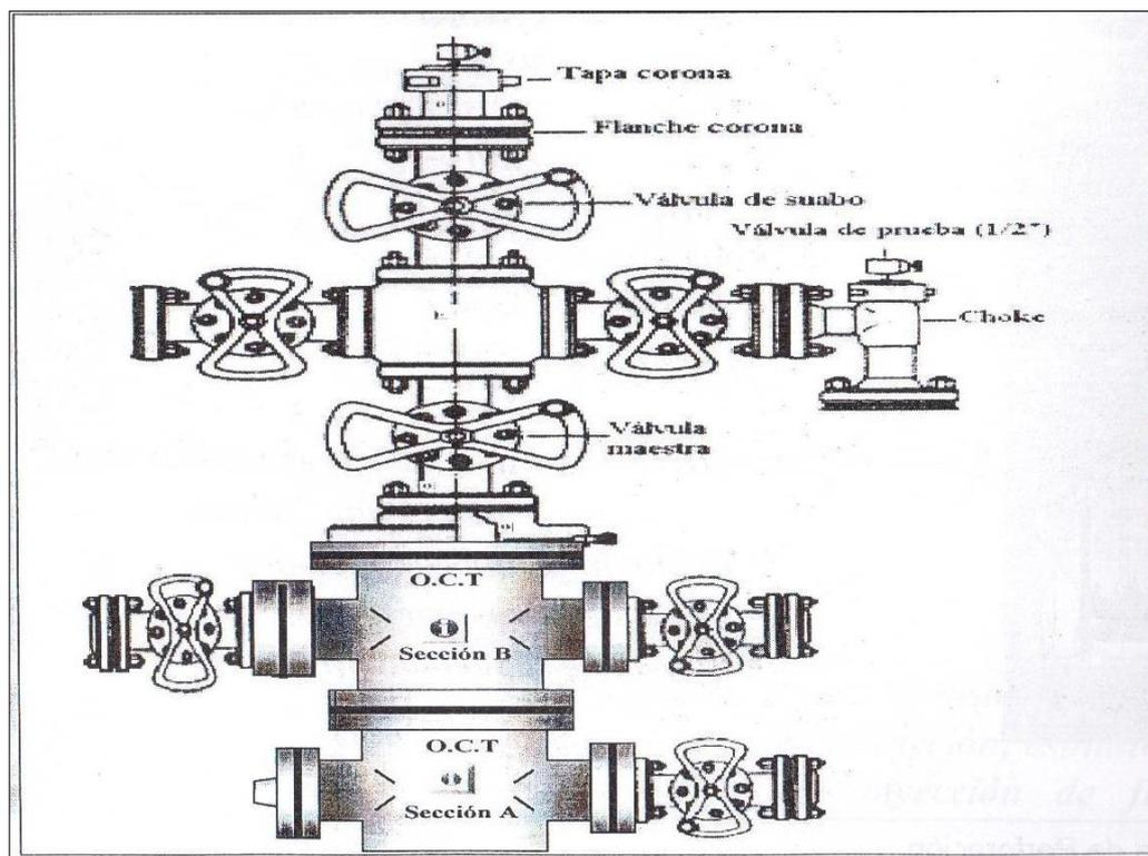
Fig. 3.13 Cabezal de pozo y sus componentes. Fuente: Curso “Ingeniería de Perforación” de Drilling Consulting.
