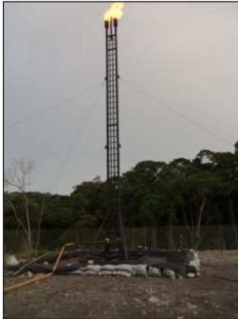
FIGURA 2.17: Mechero de encendido manual FUENTE: Elvis Gómez López y Nixon Vilcaguano Changoluisa
