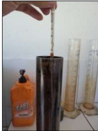
FIGURA 2.3 Toma de la densidad del petróleo en grados API FUENTE: Elvis Gómez López y Nixon Vilcaguano Changoluisa
