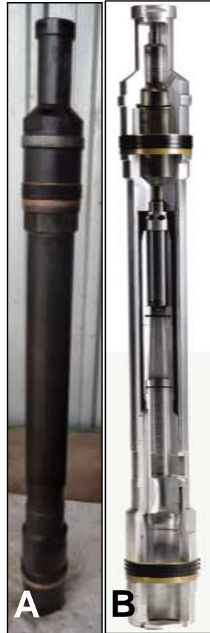
FIGURA 1.8: Bomba Jet Claw Convencional en corte (A) y normal (B) FUENTE: (A) Elvis Gómez López y Nixon Vilcaguano Changoluisa (B) Proyecto: Sistemas de adquisición de datos y monitoreo en tiempo real Claw® RTM
