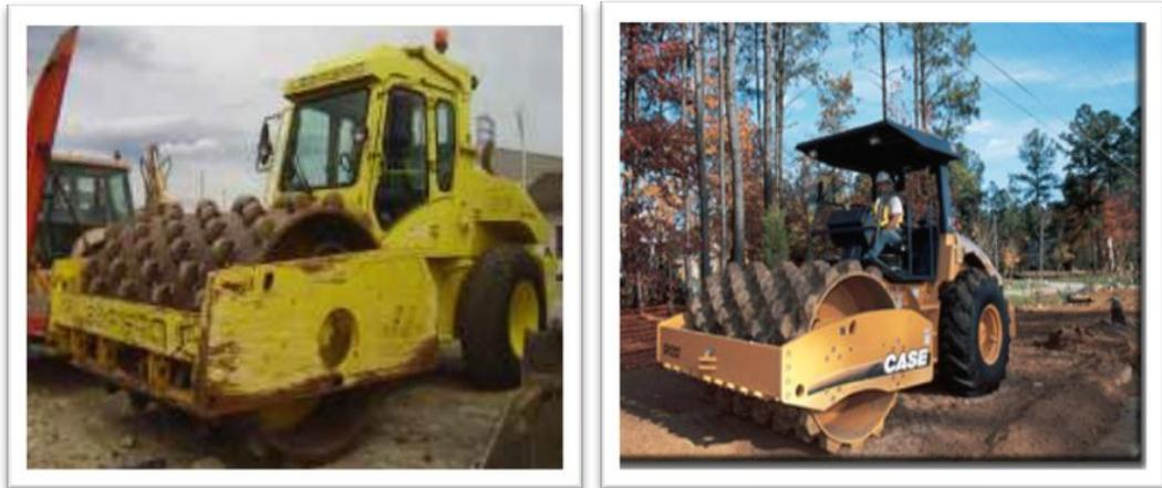
**FIGURA 3.4.14 y 3.4.15:** Rodillos Pata de Cabra
