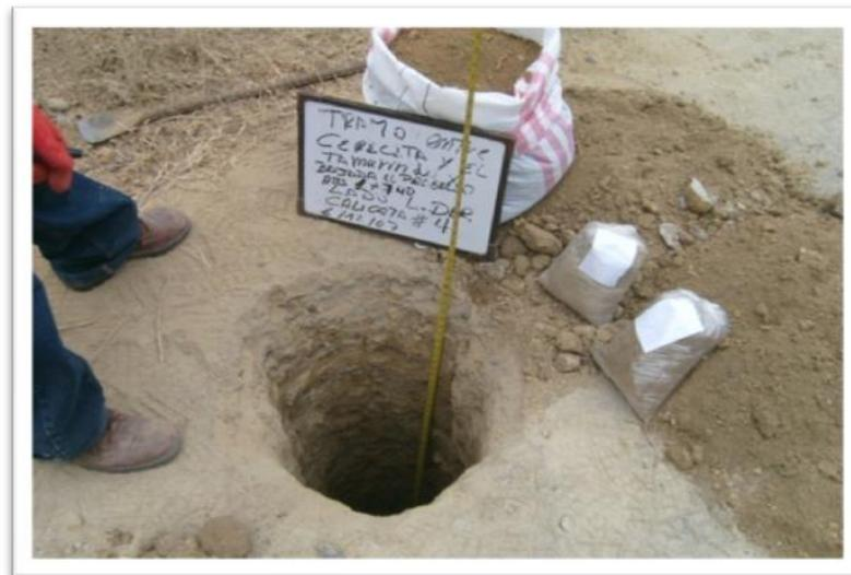
**Fotografía #21:** Excavación a una profundidad total 1.5 metros y muestras de material obtenidos de la calicata #4, abscisa 1+740 lado derecho
