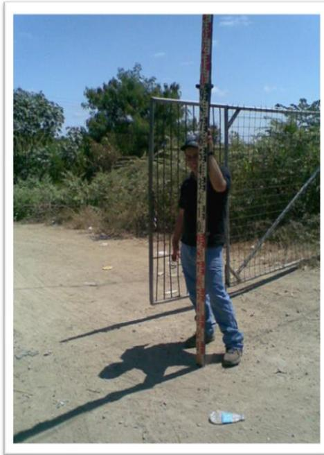
**Fotografía #12:** Nivelación Geométrica compuesta, arrastre de cotas desde IGM hasta la zona del proyecto BM #1
