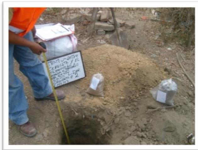
**Fotografía #19:** Calicata #2 profundidad total 1.5 metros y muestra tomada de los diferentes estratos encontrados, abscisa 0+480 lado izquierdo
