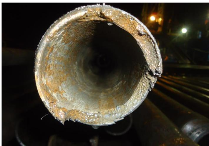
**FIGURA 5. 1: Corrosión en tubería**
