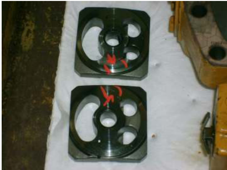
FIGURA 2.29 Platos de presión dañados por contaminación
