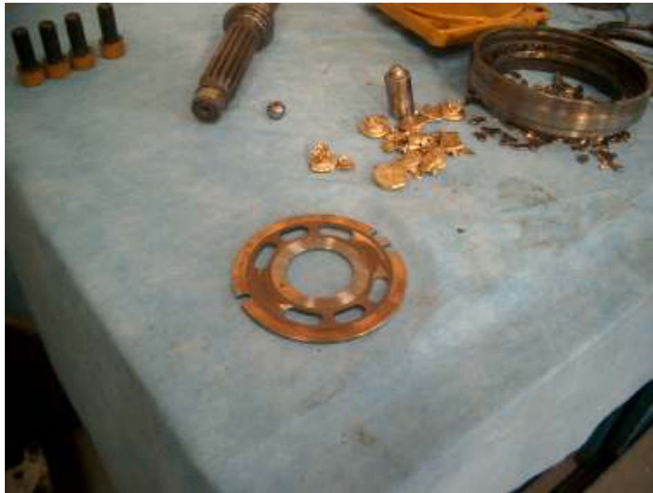
FIGURA 2.31 Daño en bomba hidráulica por tierra en el sistema.
