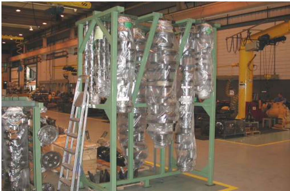
Figura 3.16 Situación recomendada: Protección componentes críticos
