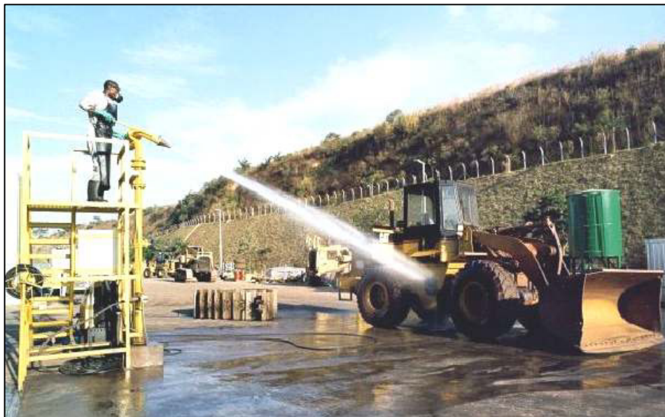
Figura 3.2 Situación recomendada: Procedimiento de lavado de vehículos
