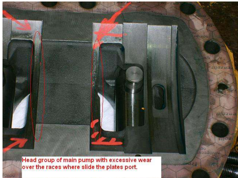
FIGURA 2.28 Acercamiento a cabezal de bomba hidráulica dañada por contaminación
