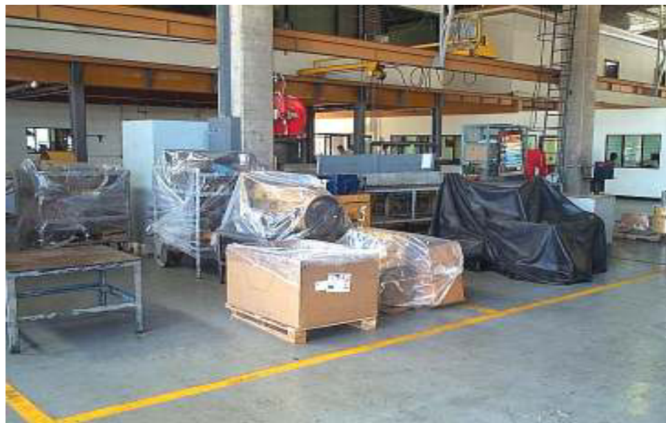
Figura 3.17 Situación recomendada: Protección componentes por armar
