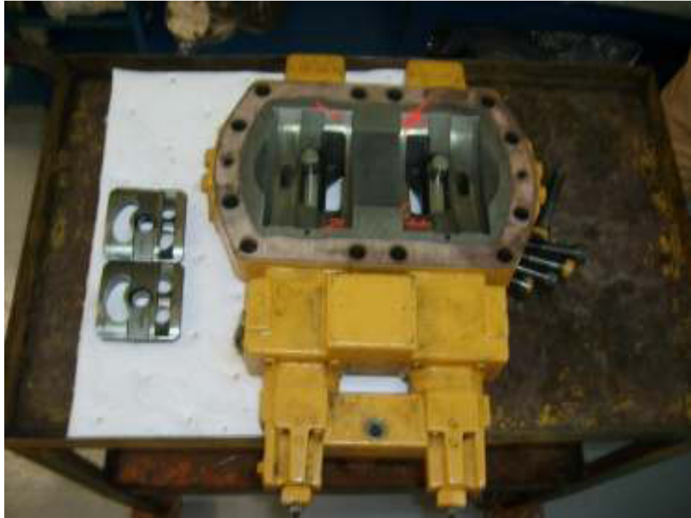
FIGURA 2.27 Cabezal de bomba hidráulica dañada por contaminación
