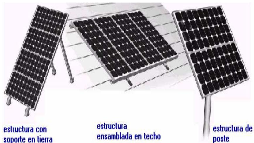
**FIGURA 3.2. TIPOS DE SOPORTES FIJOS PARA PANELES SOLARES**
