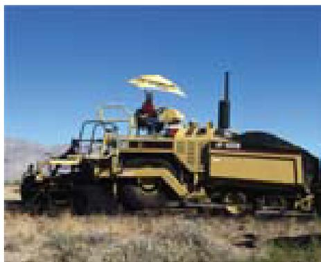
**Figura 8.10** *Pavimentadora de asfalto*
