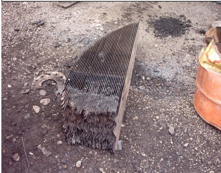
Sin embargo, las normas API acerca de dispositivos internos indican que los dispositivos internos en recipientes de presión deben ser sustituidos por otro mecanismo en caso de mostrar evidencia de corrosión o de distorsión.
