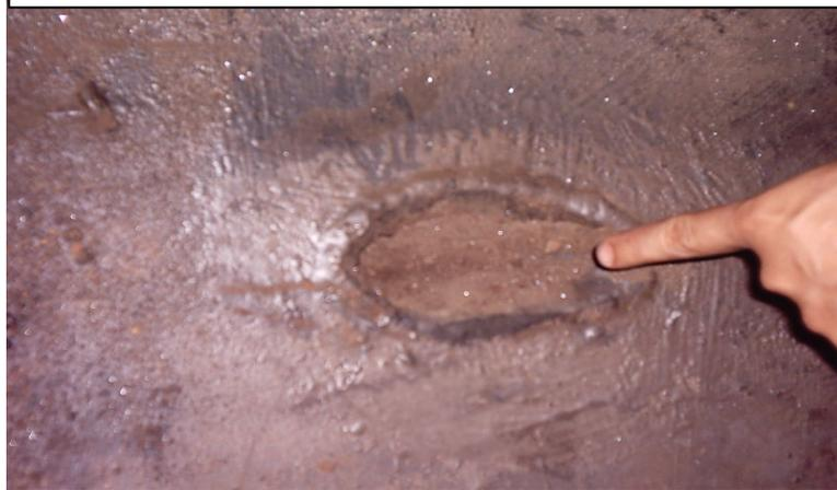
Como panza de un separador se conoce a la parte inferior del mismo, es ahí donde las planchas de acero se deterioran con mayor facilidad debido a la acción química del agua de formación que por densidad siempre se encuentra en la parte inferior del separador, causando una agresiva corrosión en la parte inferior del separador incluso en la costura del recipiente.
