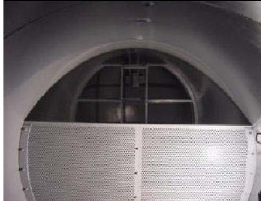
Tiene como función moderar el régimen de flujo de turbulento a laminar con el fin de mejorar la separación de las moléculas de gas en la corriente de líquido y evitar la formación de vórtices. Estas placas rompedoras de olas tienen una distribución homogénea de orificios de  $\frac{1}{4}$ " por donde pasa el flujo.
