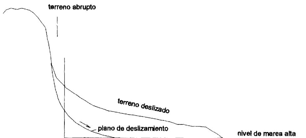
Figura 4.4: Perfil de deslizamientos según las suposiciones hechas para el cálculo de volumen deslizado presente en el Peñón Mayor. Comparar con la figura 4.2. El cálculo se hizo restando a la topografía, el nivel de marea alta.
