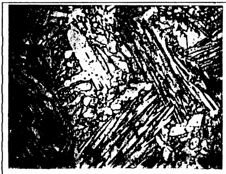
Figura 27: Microestructura de probeta extruida 5. V : 25.4 mm/s, T : 650 C, R : 1.36. Dureza: 87.7 Brinell. Se divide en 2 fases \alpha y \beta con inclusiones de Plomo
