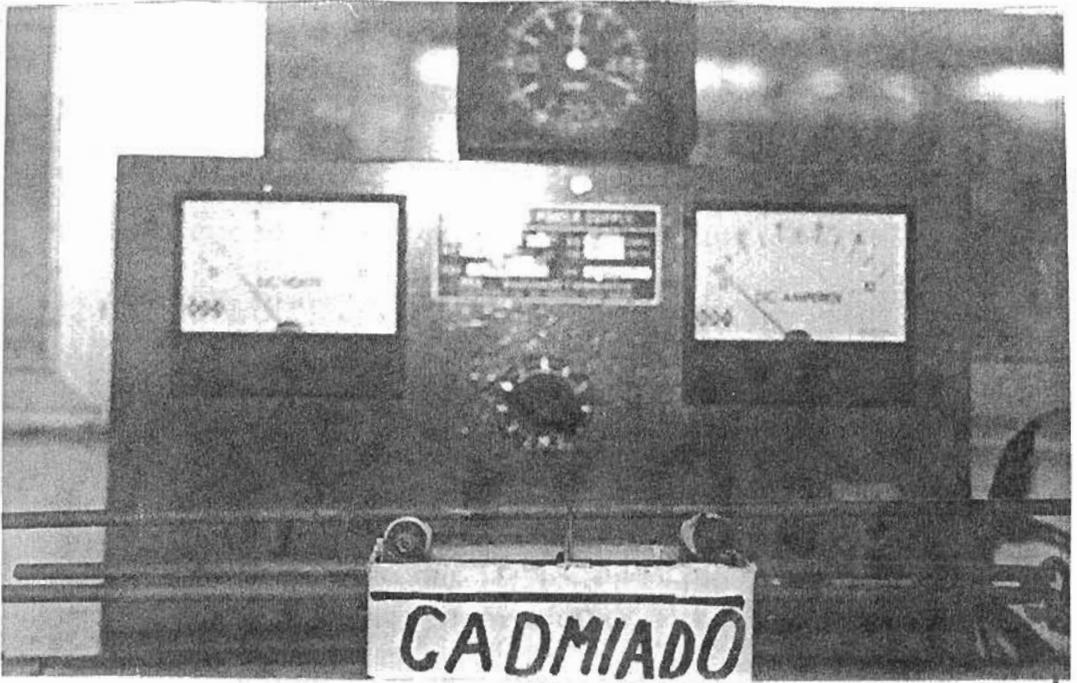
Figura. N° 3. Transformador - rectificador.
