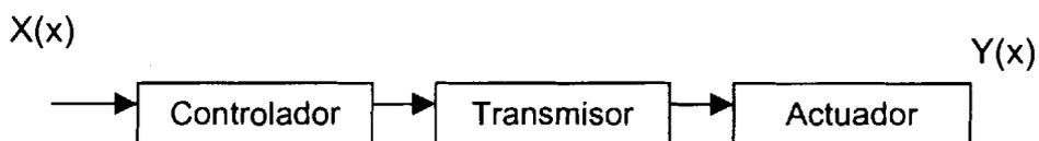
**FIGURA 3.27** Esquema de sistema de Control de lazo abierto.
