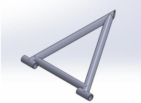
Figura 19.- Brazo de suspensión delantero superior
