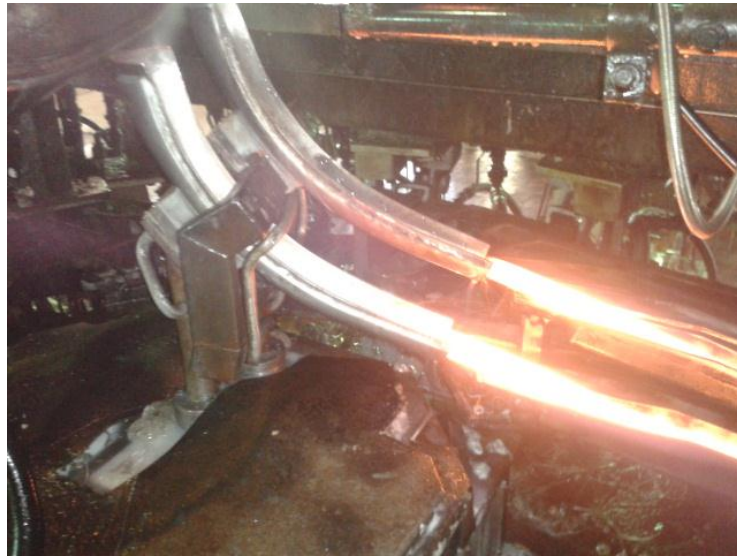
Figura 2.7. Distribuidor de gota de vidrio entrega a diferentes secciones
