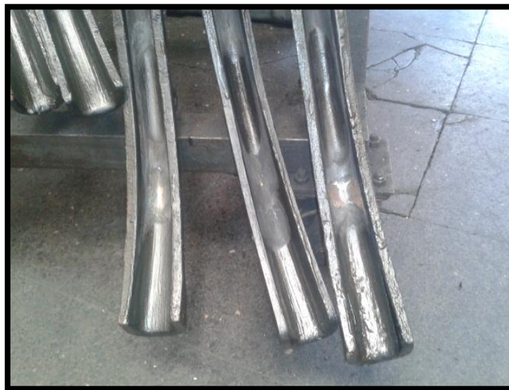
Figura 3.8. Curvatura de deflectores desgastados Fuente: Elaboración propia
