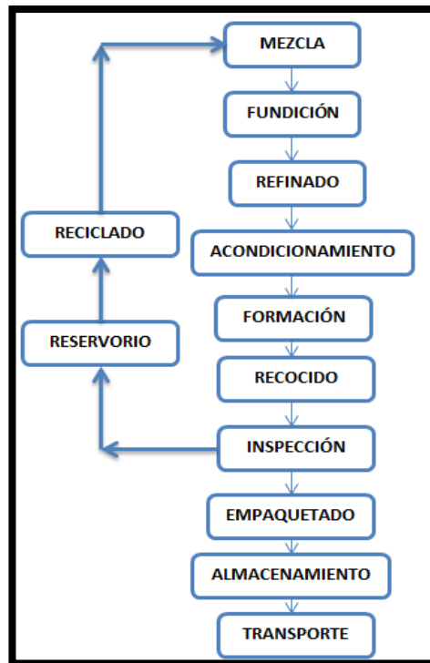
Figura 1.4. Diagrama de proceso de la producción de vidrio
