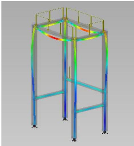
**Figura 31.** Cargas aplicadas en la estructura de la mesa soporte.
