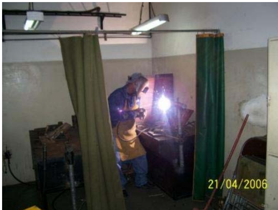
FIGURA. 3.4 FOTOGRAFÍA DEL OPERADOR SOLDANDO EN POSICIÓN 3G.
