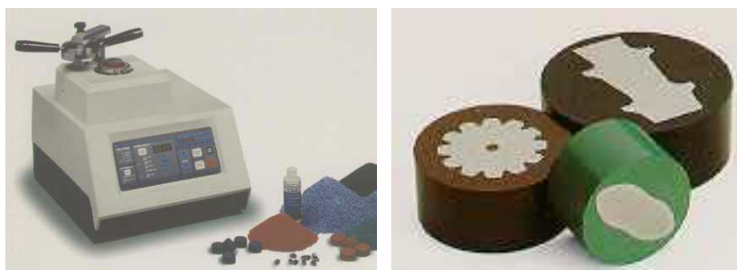
FIGURA. 1.22 PREPARACIÓN DE PROBETAS METALOGRÁFICAS, EQUIPO DE EMBUTICIÓN EN CALIENTE, Y MUESTRAS EMBUTIDAS.
