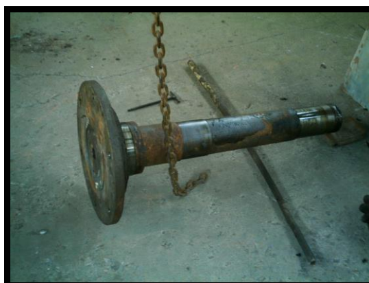
FIGURA 1.4. EJE DESMONTADO DE LA BASE SUPERIOR
