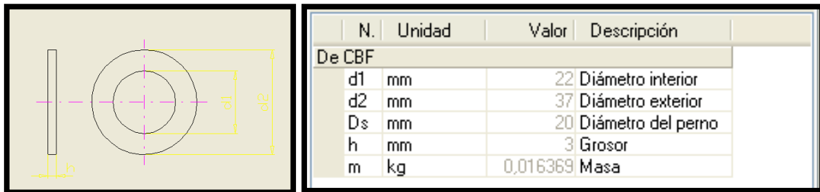
FIGURA K-3-20. DIMENSIONES GENERALES DE LAS ARANDELAS
