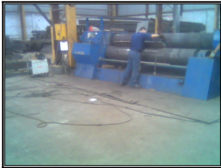
FIGURA 2.8 PRE-ROLADO DE LÁMINA
