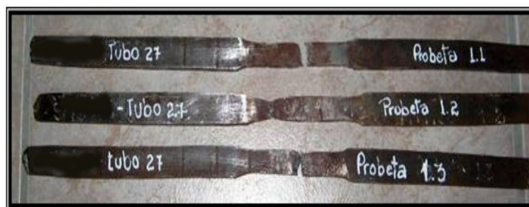
FIGURA 3.12 PROBETAS LUEGO DEL ENSAYO DE TRACCIÓN TUBO NO. 27
