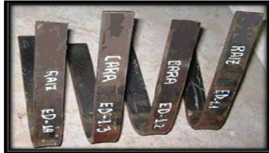
FIGURA 3.7 PROBETAS DE DOBLADO TUBO NO. 27 LUEGO DEL ENSAYO
