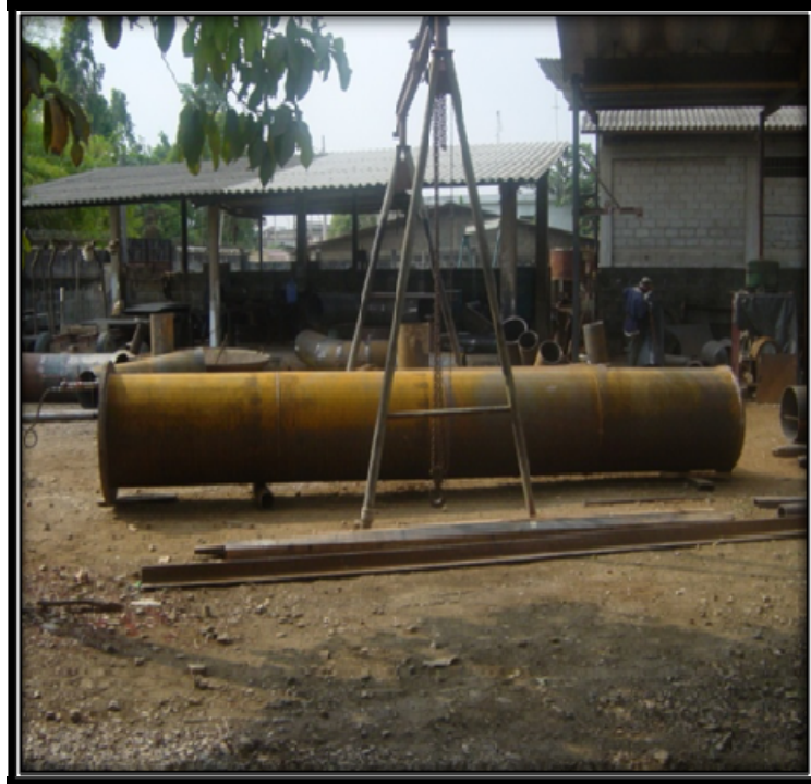
FIGURA 1.7 VISTA DEL SEGMENTO DE TUBO TERMINADO DONDE SE OBSERVAN LA CANTIDAD DE TRAMOS QUE LO COMPONENTEN
