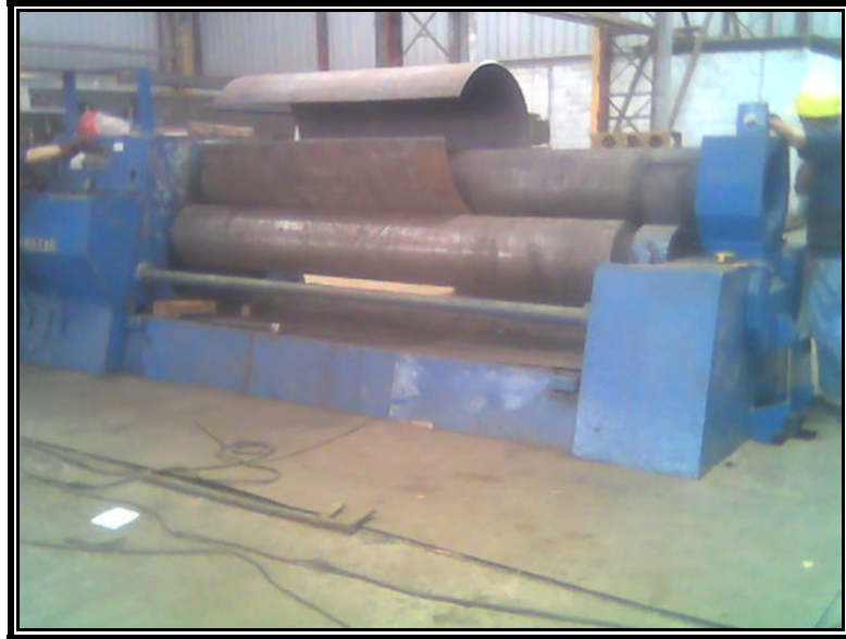
FIGURA 2.9 PROCESO DE ROLADO ARTESANAL
