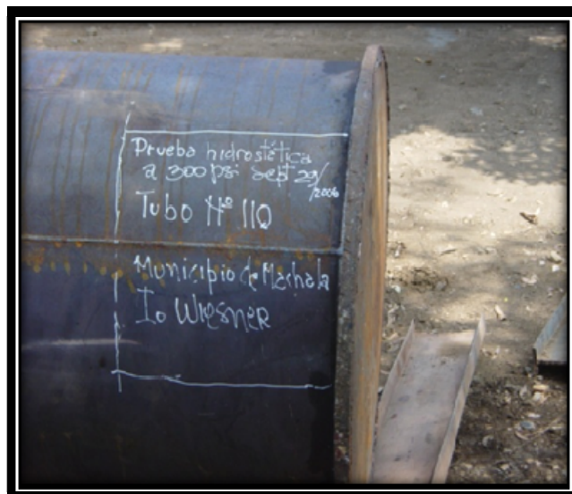
FIGURA 3.4 MUESTRA DEL TUBO NO. 110 ENSAYADO HIDROSTÁTICAMENTE A 300 PSI.
