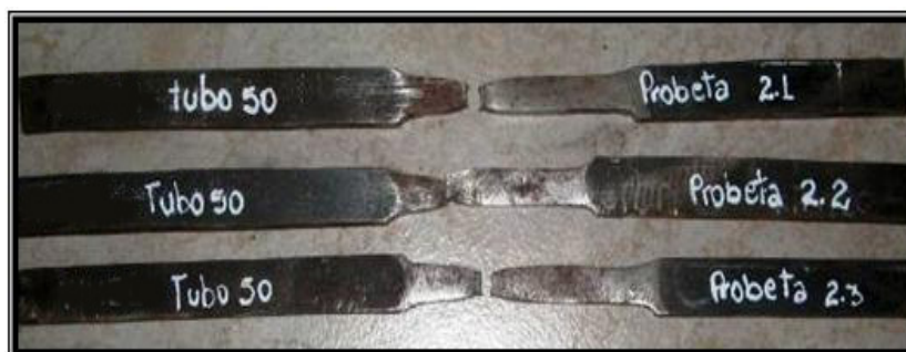
FIGURA 3.13 PROBETAS LUEGO DEL ENSAYO DE TRACCIÓN TUBO NO. 50
