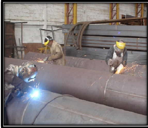
FIGURA 2.11 PROCESO DE SOLDADURA CON PROCESO MIG PARA ENSAMBLAJE DE TRAMOS NODULARES PARA HACER SEGMENTOS LARGOS DE 6 M.
