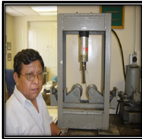
FIGURA 3.6 EN ESTA FOTO EL AUTOR DE ESTE INFORME JUNTO A LA MAQUINA PARA ENSAYO DE DOBLADO
