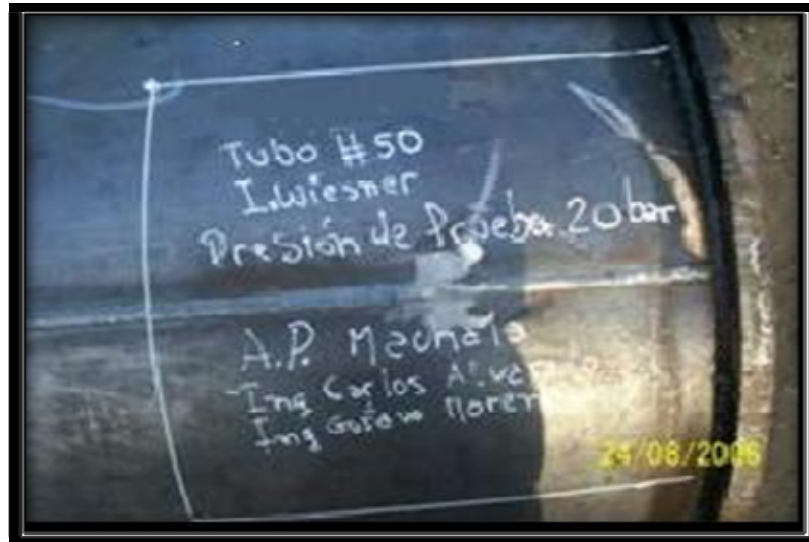
FIGURA 3.3 IDENTIFICACIÓN DE LA MUESTRA PARA ENSAYOS DEL TUBO
