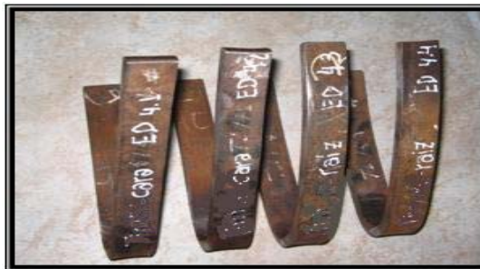
FIGURA 3.10 PROBETAS DE DOBLADO TUBO NO. 142 DESPUES DEL ENSAYO
