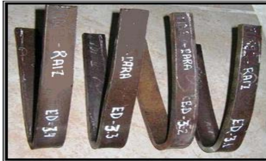
FIGURA 3.9 PROBETAS DE DOBLADO TUBO NO. 110 LUEGO DEL ENSAYO
