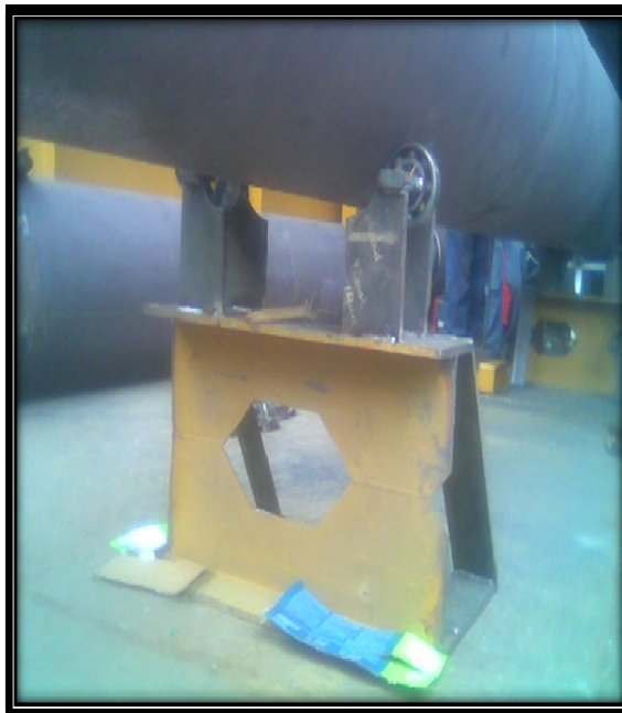
FIGURA 2.12 DETALLE DE SOPORTE QUE PERMITEN EL MOVIMIENTO GIRATORIO Y REALIZAR EL TRABAJO EN UNA POSICIÓN
